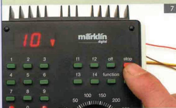
7. Durch Drücken der „stop“-Taste wird der Programmiermodus beendet.
