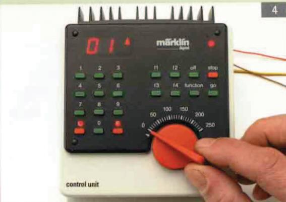
4. Über das Eingeben der Registernummer „01“ und einen anschließenden Fahrtrichtungswechsel-befehl kommt man zum Programmiermodus der Lokadresse.
