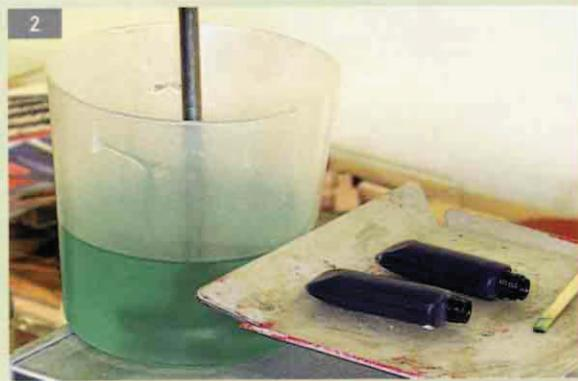
2. Zweikomponenten-Gießharz setzt sich aus dem eigentlichen Gießharz und einem speziellen Härter zusammen, ...
