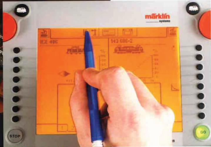
*In der oberen Menüleiste findet sich das Symbol zum Einrichten der Schaltdecoder, kenntlich an Weiche und Signal.*
