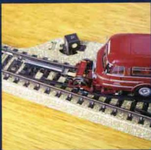
*Mitte Links. Der Schleifer ist unter dem vorderen Laufgestell untergebracht. Je nach Blickwinkel ist der Schleifer mehr oder weniger deutlich zu sehen.*
