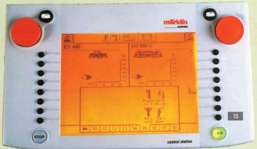
15. Im normalen Betrieb erscheinen die Magnetartikelsymbole im unteren Display-Bereich auf der ihnen zugewiesenen Bedienebene.
