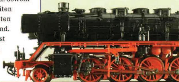
Reichhaltig detailliert ist Rocos Lok nicht nur im Bereich des Fahrwerkes. Um die Lok auf kleinen Radien einsetzen zu können, sind die Kolbenstangenschutzrohre als Zurüstteile beigelegt. Positiv ist die vorhandene Bremsausrüstung an allen fünf Kuppelachsen.
