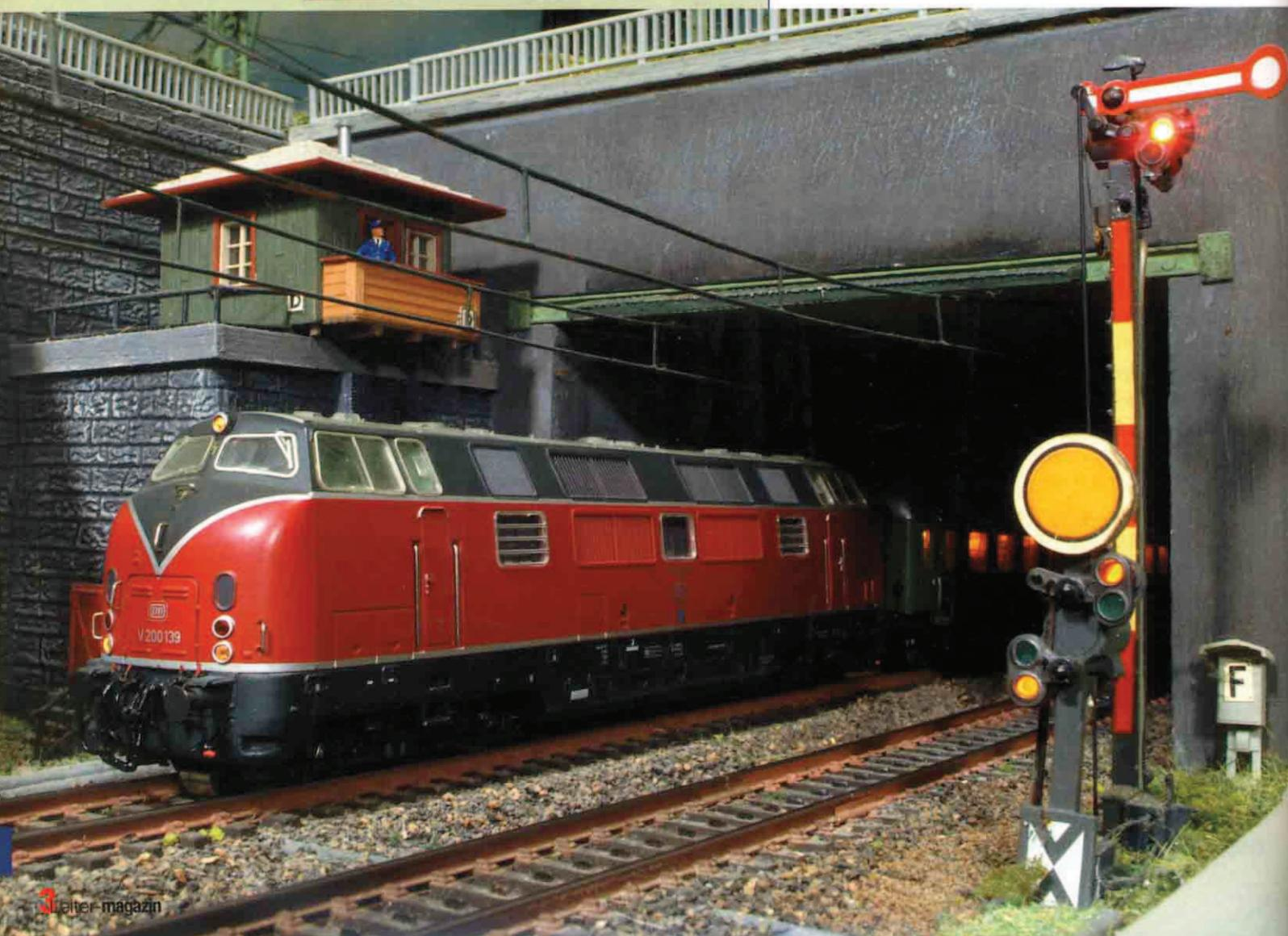
lieferten Steckglühlampen sind schon auf die höhere Digitalspannung ausgelegt. Um deren Fassungen einzubauen, braucht man nur die bisherigen Kontaktplatten hinter den Lampenhalterungen zu entfernen und sie durch die neuen Halterungen zu ersetzen. Sie können mit Sekundenkleber schnell befestigt werden.
