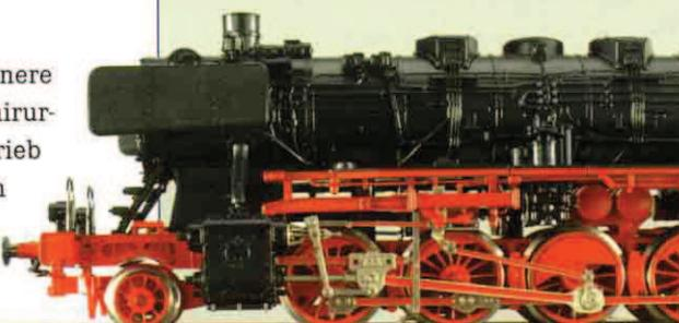
Aus Gründen des Fahrverhaltens fehlen bei Fleischmann Kolbenstangenschutzrohre sowie die Bremsen an der ersten Achse komplett. Ansonsten sind Steuerung und Kessel gut nachgebildet. Fotos (3): Kurt Heidbreder
