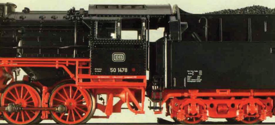
*Führerhaus und Tenderbühne bilden bei Roco ein echtes Führerhaus und verbergen geschickt die Lok-Tenderverbindung sowie die Kardanwelle. Alle Anschriften sind großentrichtig und gestochen scharf.*
