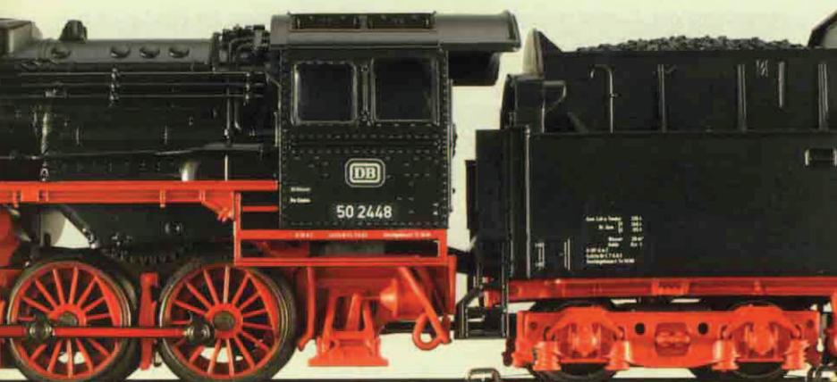
*Der Spalt zwischen Lok und Tender ist bei Märklin gering und kann entsprechend den Erfordernissen verändert werden. Die Anschriften sind scharf. Störend wirken sich nur die Beulen im Stehkessel (links), die sichtbaren Zahnräder sowie die sehr weit zurückversetzte Stehkesselrückwand aus.*
