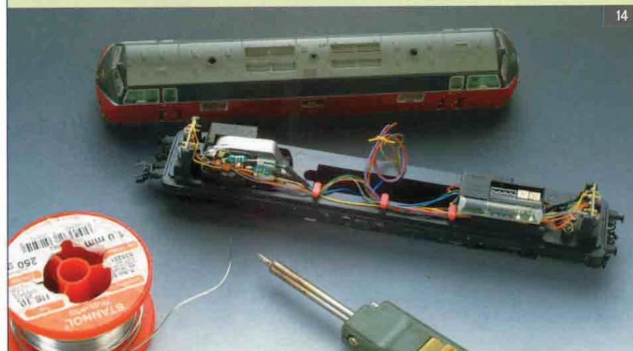
11. Der Umrüstsatz 60901 enthält alle Teile, die für den Umbau einer Trommelkollektormotor-Lok wie der V 200.1 auf Digitalbetrieb benötigt werden.
