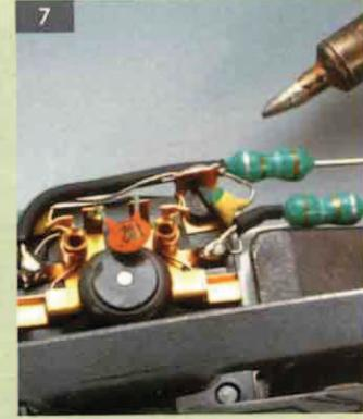
6. Die beiden kleinen Plattenkondensatoren lötet man im Anschluss daran an den beiden dafür vorgesehenen Kontaktpunkten des Motorschildes an.
