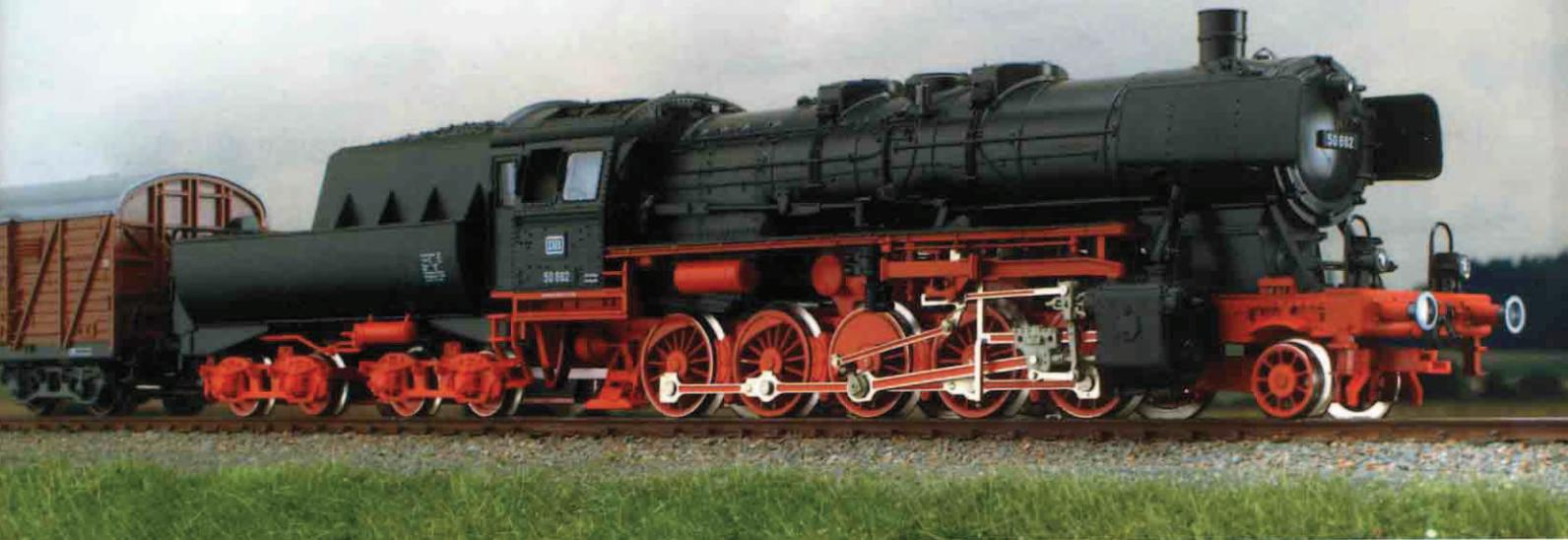
Märklins ältere, wenn auch vor einigen Jahren in vielen Bereichen überarbeitete 50 ist in einigen Details robuster ausgeführt, was leider etwas zu Lasten des optischen Gesamteindrucks geht. Mit dem Märklin-typischen Knickfahrwerk lässt sie sich sogar noch auf den engsten Industrieradien des M-Gleises einsetzen. Das Gut in der Bewertung entspricht dem gebotenen Preis-Leistungsverhältnis. Doch auch Fleischmanns 50 muss sich nicht verstecken: im Analogbetrieb auf ebener Strecke bietet
