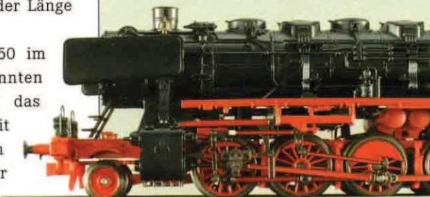
Märklins 50 besitzt abweichend einen Scheibenradsatz im Vorlaufgestell. Wer nur auf größeren Radien fährt, kann Kolbenstangenschutzrohre nachrüsten. Steuerung und Fahrwerk sind zeitgemäß, allerdings fehlt die Bremse an der ersten Kuppelachse.
