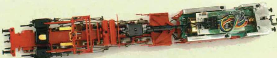
Bei Roco sorgen Lok und Tender dank der Verbindung mit einer Kardanwelle gemeinsam für den Antrieb. Dieses Konzept sichert hohe Zugkräfte, macht die Wartungsarbeiten jedoch komplizierter.
