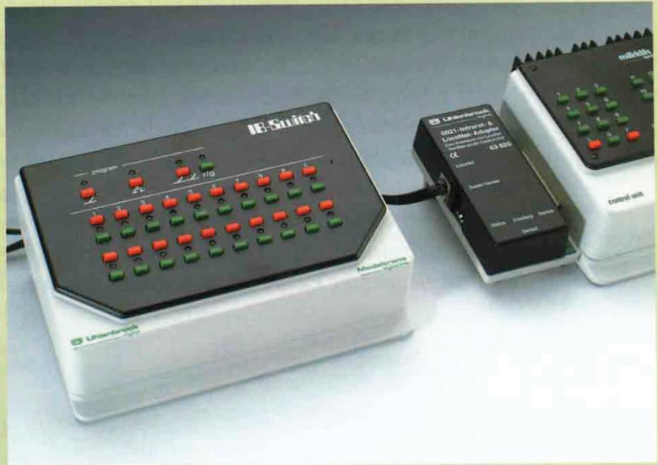
bekanntem fünfpoligen Anschluss (Boosteranschluss) mit Märklins Control Unit verbunden wird, wird der Handregler über den Adapter an das LocoNet angeschlossen. Schafft man die nötigen Anschlussbuchsen an allen betriebswichtigen Punkten, ist man mit Daisy immer auf der Höhe des Geschehens.
