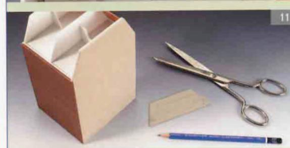
11. Aus Polystyrol fertigt man die Unterkonstruktion für das Dach. Zuvor wird die Form mit einer Schablone aus Pappe ermittelt.
