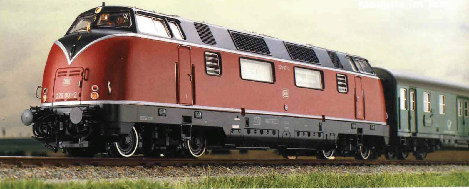
Modell aufgedruckt. Die Anschriften sind größenrichtig und auch unter einer Lupe gestochen scharf. Alle Griffstangen sind freistehend ausgeführt, zeigen jedoch einen nicht dem Vorbild entsprechenden Kupferglanz.
