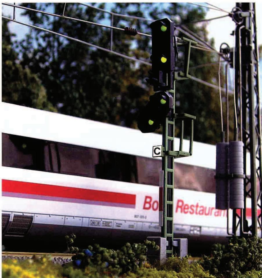
Das Viessmann-Steuermodul für Lichtsignale 5224 stellt zwei Signale, ein Haupt- und ein Vorsignal.
