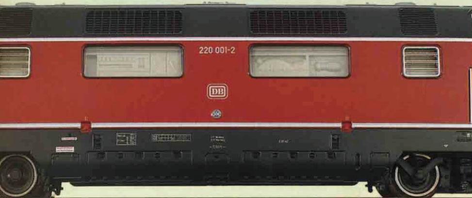
*220 001 von Roco trägt epochengerecht den auflackierten DB-Keks. Auch an die Klappe zur Wasserbefüllung des Heizkessels wurde gedacht.*
