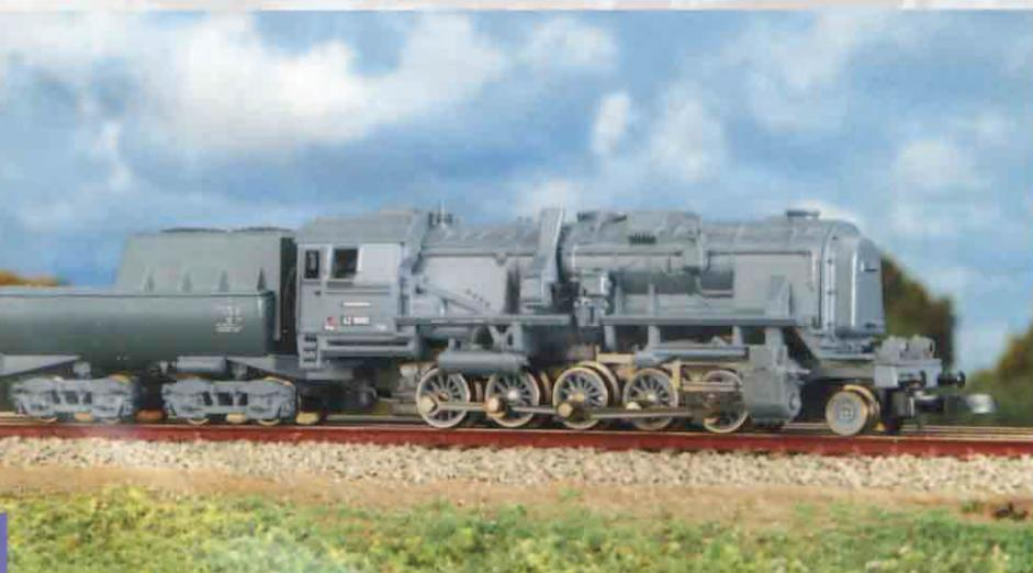
Vorwärmung des Kesselspeisewassers einen zusätzlichen Röhrenkessel auf der Lok vorzusehen. Hierdurch war es möglich, das Wasser siedend heiß in den Kessel eintreten zu lassen.
