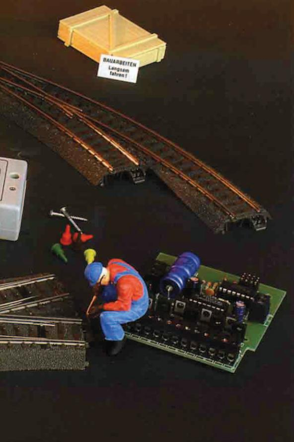
1. Bei Viessmanns Weichendecoder 5211 ist das „Mäuseklavier“ von außen zugänglich. Als Schaltspannung kann eine separate Wechselfspannung eingespeist werden.
