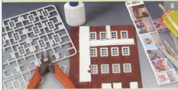
8. Vorhänge aus Ausschneidebögen kommen als Fensterdekoration in Frage. Gestückelte Fassadenteile erhalten von hinten breite Kunststoffstreifen zur Stabilisierung der Klebenähte.
