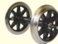
V-Speichenradsatz aus Vollmetall; Radsterne aus Zinkdruckguss; extern aufgespresster Radreifen aus vernickeltem Messing; Achslänge 70 mm, passend für alle Fremdfabrikate; Inhalt 2 Stück.
