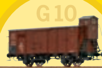
Gedeckter Güterwagen der Verbandsbauart mit Bremsenhaus der K.P.E.V.
