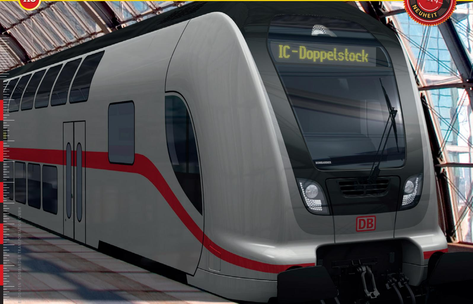
Ende 2010 erhielt Bombardier Transportation einen Auftrag über 27 fünfteilige Bombardier TWINDEXX Vario Doppelstock-Wendezüge der Generation 2010. Die Zugverbände mit Komfort-Ausstattung für den Fernverkehr bestehen aus jeweils drei 2. Klasse-Mittelwagen, einem 1. Klasse-Mittelwagen und einem 2. Klasse-Steuerwagen. Der TWINDEXX Vario ist eine Weiterentwicklung der bewährten Doppelstockplattform aus Görlitz. Pro Zug stehen 468 Sitzplätze, davon 70 in der 1. Klasse sowie 9 Fahrrad-
