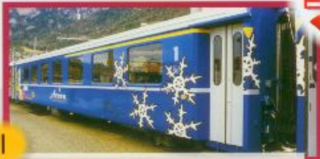
Einheitswagen EW II: 1975-1979 beschaffte die RhB 38 Einheitswagen EW II der 1., 1./2. bzw. 2. Wagenklasse für das Stammtzetz.
