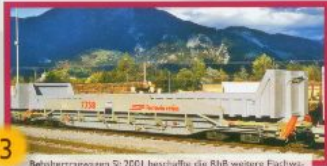
Behältertragwagen SI 2001 beschaffte die RhB weitere Fachwagen für den universellen Transport von Mulden bzw. Wechselbehältern aller Art.
