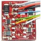
Ausgänge dimmbar, Timerfunktionen, Richtungsabhängigkeit, Pendelautomatik, Bremsautomatik und INDUSI, DCC bis F28, Rangiergang und abschaltbare Zugmasse. Auch geeignet für LGB-MZS Pulskettenausgabe. Anschluss für Speicherkondensator SPK22E. Anschluss über Klemmleiste (DLE2M) oder Kabel (DLEV3).
