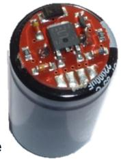
Kondensatoren mit Ladeelektronik zum Anschluss an diverse Lokdecoder.
