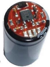
Kondensatoren mit Ladeelektronik zum Anschluss an diverse Lokdecoder.
