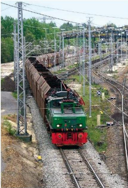
**Ein Zug mit 4-T185 verlässt die Kohleverladeanlage Welzow-Süd. Für Fahrleitungen in Seitenlage hat die Lok kleine Stromabnehmer**
