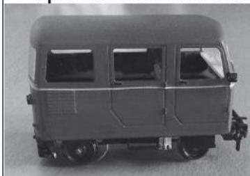
Gehäuse 3D gedruckt, vormontierter Antrieb.
