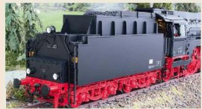
Der Tender der Bauart 2'2' T 34 wiegt 2,37 Kilogramm. Die Wasserkastendeckel sind beweglich. Im Tenderinneren verbergen sich ESU-Decoder und Lautsprecher
