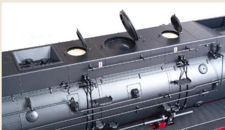
Auf dem verkleideten Kesselscheitel – einer Besonderheit bei der DR-01<sup>5</sup> – sind sogar die Deckel von Dampfdom und Sandkästen klappbar
