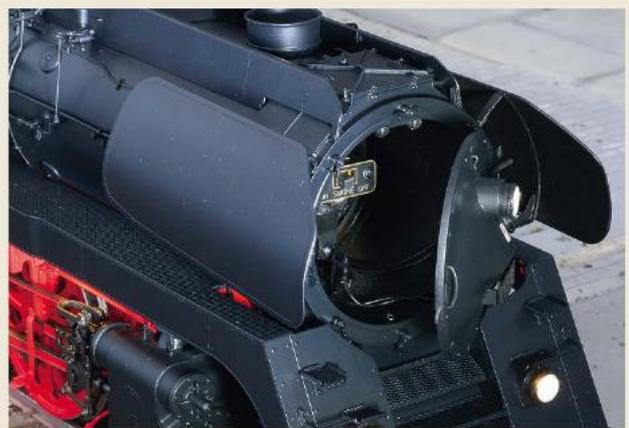
Die Rauchkammertür – hier die spitze DR-Version ohne Zentralverschluss – lässt sich öffnen. Der Schalter steuert den Rauch
