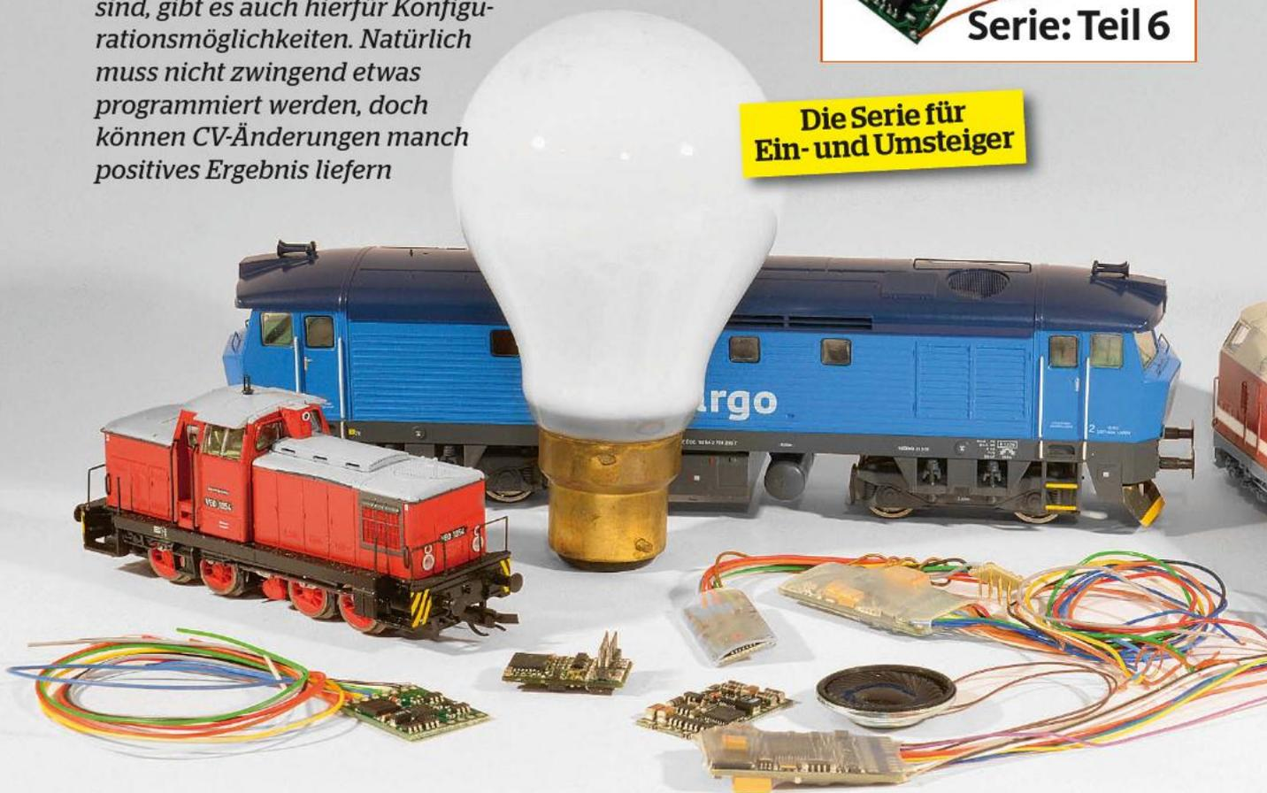
Am wichtigsten beim Programmieren von Digitalfunktionen eines Decoders ist das so genannte Function Mapping, womit die Zuordnung zwischen Funktionstaste am Handregler und dem Funktionsausgang am Decoder zugewiesen wird. Ab Werk ist das stets folgendermaßen voreingestellt: Taste 1 schaltet Ausgang 1 usw. Aber das kann je nach Vorliebe des Anwenders und Verdrahtung im Triebfahrzeug auch manchmal unzweckmäßig sein.
