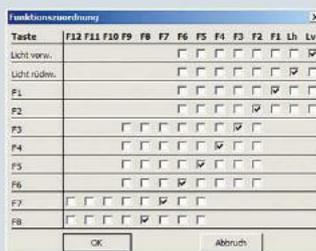
Beim Programm P.f.u.Sch., das z. B. in Verbindung mit dem Zimo-MXULF verwendet werden kann, ist eine einfache Funktionszuordnung möglich
