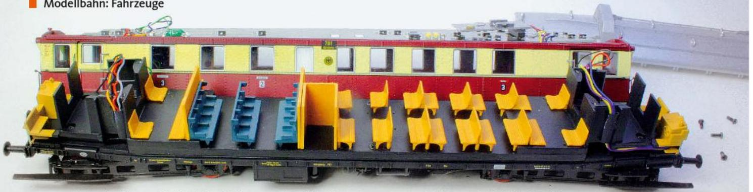
**Zerlegtes Wumag-VT-Modell mit Klassen-unterschiedlicher Innenraumgestaltung, gut detaillierten Führerständen und der Elektronik-Platine unter dem abgenommenen Dach; im Vergleich dazu die Innenansichten des museal erhaltenen T 175, nach denen man das Modell farblich optimieren könnte**
