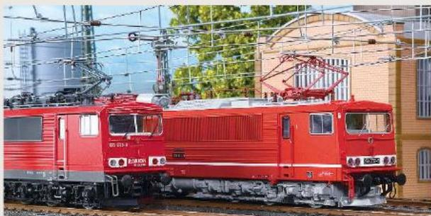
Im Vergleich von Roco- und Gützold-Modell sind die Detailverbesserungen (links) bei Scheibenwischern oder Führerstand erkennbar
