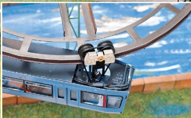
*Das Laufgestell an der Zugspitze wird vom Getriebemotor im Wagenkasten über einen Riemen angetrieben*
