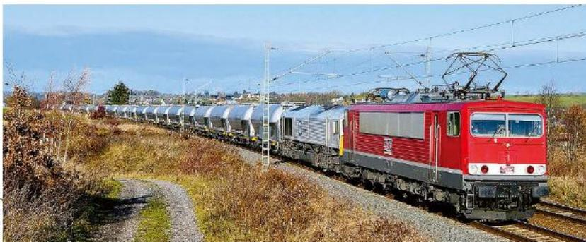
**Die als MEG 710 bei der Mitteldeutschen Eisenbahn eingestellte 155 059 bespannte am 14. November 2015 den Zementleerzug DGS 88979 von Regensburg nach Rüdersdorf bei Steinpleis. Als Wagenlok ist noch 077 012 in den Zug eingereiht**
