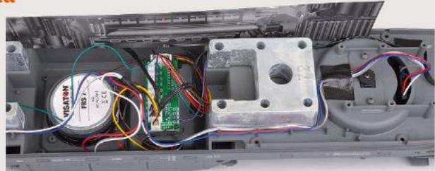
Audioverstärker auf Zehn-Volt-Basis in Verbindung mit dem Acht-Watt-Lautsprecher sorgt für einen vollen Klang, der sicherlich auch noch im Nachbargarten zu hören ist. Außerdem sind acht Funktionsausgänge vorhanden. Wer Servos für die Kupplungen einbaut, kann diese ebenso anschließen wie einen getakteten Raucherzeuger. Dank einer aussagekräftigen Anlei-
