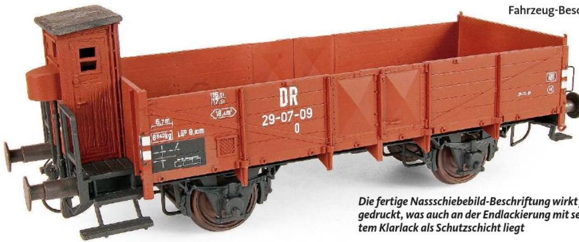
Die fertige Nassschiebebild-Beschriftung wirkt fast wie gedruckt, was auch an der Endlackierung mit seidenmattem Klarlack als Schutzschicht liegt
