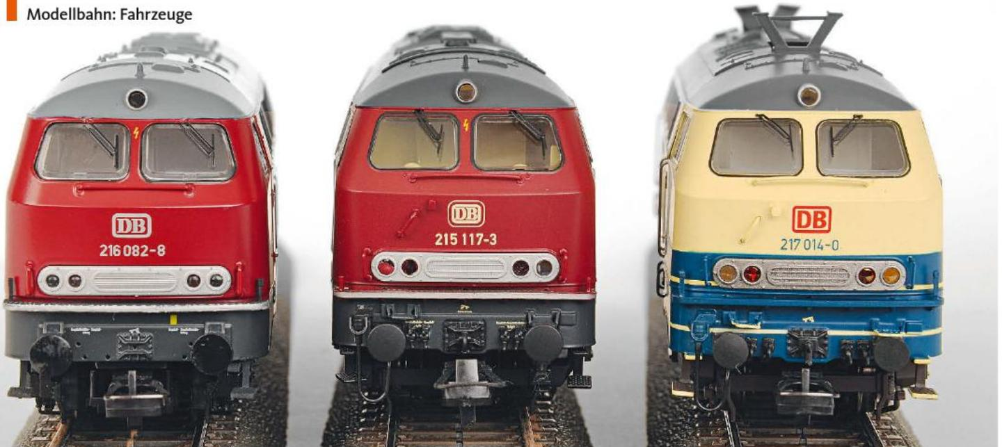
Bei der Frontansicht fallen die Bohrungen für die Zurrüstteile an der Brawa-Lok (links) auf. ESU und Liliput haben die Modelle bereits ab Werk zugerüstet
