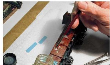
Wenn Schiebebilder – wie hier am O-Wagen – über Bretterfugen liegen, werden sie mit dem Skalpell aufgeschnitten und ein- oder mehrmals mit Weichmacher-Flüssigkeit eingestrichen, bis sie sich sauber an den Untergrund anschmiegen
