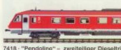
7418 - "Pendolino" – zweiteiliger Dieseltriebzug mit Neigetechnik
