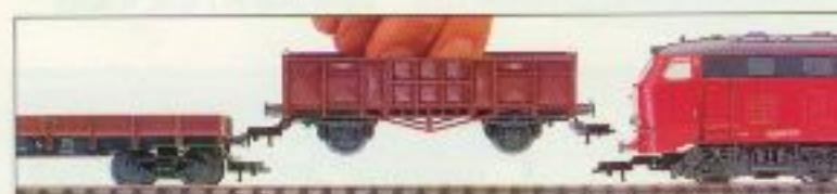
Die Kupplungen ermöglichen ein leichtes Herausheben von Wagen aus einem Zugverband
