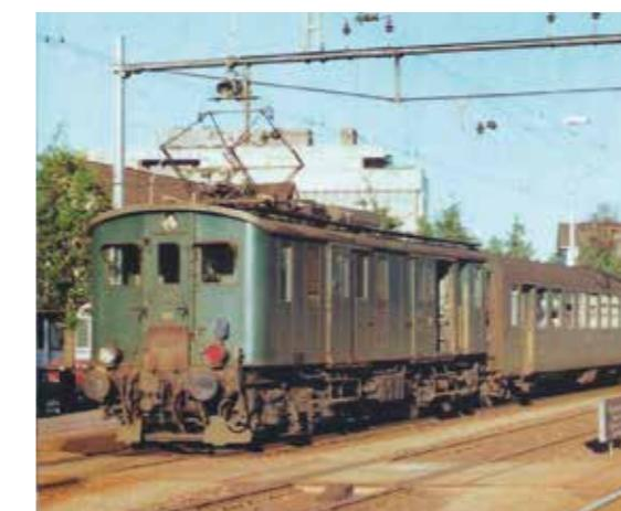
Für den Regionalverkehr wurden in den 20iger Jahren neue Triebfahrzeuge benötigt. Es wurden 1927/28 insgesamt 24 Gepäcktriebwagen Typ Fe 4/4 (F für Gattung Gepäckwagen), später ab 1963 als De 4/4, in Auftrag gegeben. Die Wagen wurden mehrmals umnummiert und auch umgebaut. Die Fahrzeuge wurden auch als «Seetalbahn» eingesetzt, dies mit 800er Nummerierung. Ein Fahrzeug (Fe 4/4 Nr. 813, resp. De 4/4 Nr. 1673) kam auch auf der BT (Bodensee-Toggenburg-Bahn) zum Einsatz.
