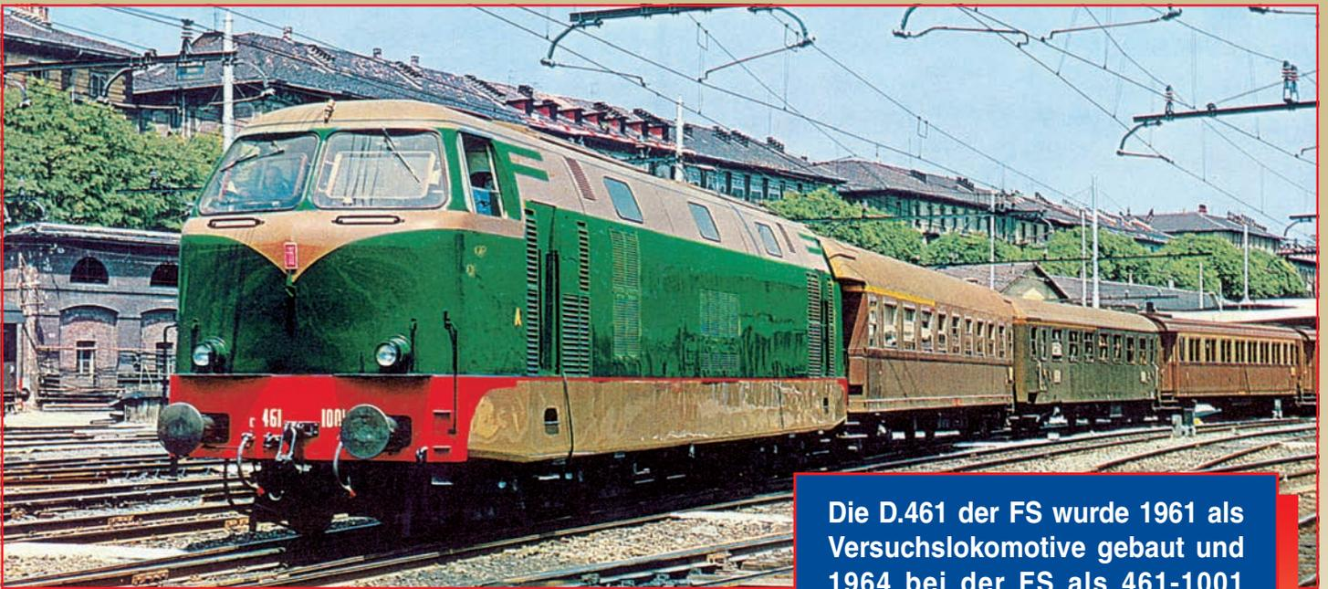
Die D.461 der FS wurde 1961 als Versuchslokomotive gebaut und 1964 bei der FS als 461-1001 eingereiht. Sie blieb aber für immer die einzige CoCo-Diesel-Lok Italiens und wurde bereits 1979 außer Betrieb genommen. Bis 2002 befand sich dann die Lok im Eisenbahnmuseum Piemont. Nun wird sie überarbeitet, um mit Sonderzügen eingesetzt zu werden.
