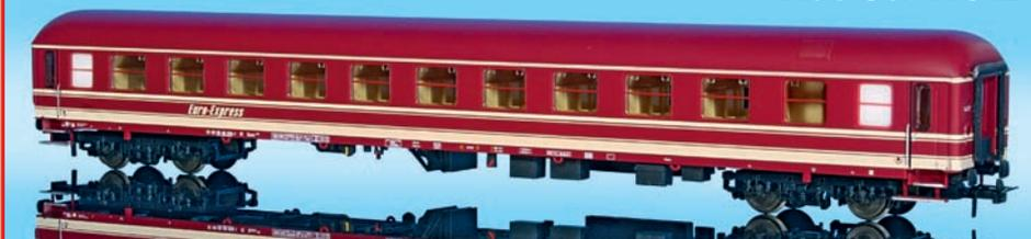
Der Einheitsliegewagen vom Typ Bc4üm-62 später Bcüm243 wurde insgesamt in 464 Exemplaren an die DB geliefert, dies erfolgte in den Jahren 1962 bis 1972. Der Wagen nach UIC Typ X verfügt über zehn Reiseabteile mit je sechs Liegen, sowie ein Begleiterabteil. Der Umbautyp BCmh 246 befindet sich im Set Autoreisezug (Artikel Nr 11025). Auffälligste Veränderung des Umbaus ist wegen der zentralen Entlüftungsanlage, die geänderte Fenster-einteilung und das glatte Dach mit dem Lüftungsgitter.
