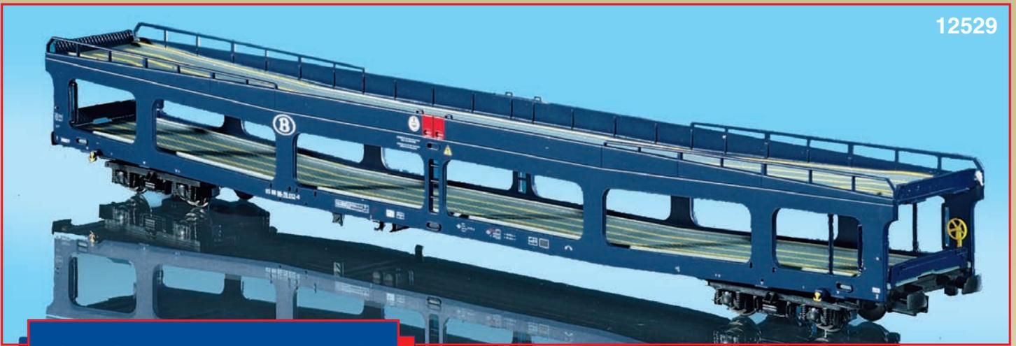
Diese Autotransportwagen französischer Bauart der SNCB wurden mit belgischen Drehgestellen ausgerüstet.
