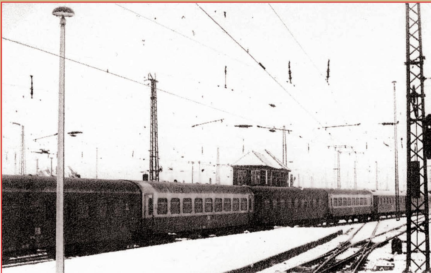
Am 16. Februar 1979 wird in Leipzig-Hauptbahnhof der Eilzug 777 nach Karl-Marx-Stadt (Chemnitz) bereit gestellt. Die Aufnahme zeigt den bunten Wagenpark des Zuges, der zur Hälfte aus Reko-Wagen des Typs Bghw bestand. In der Reihe der Reko-Wagen verteilt sieht man zwei der insgesamt vier Wagen mit den Testlackierungen. Ein Set mit allen vier Wagen in Testlackierung wird bei HERIS im Maßstab H0 unter der Katalognummer 80011 angeboten. Foto: K. Brust
