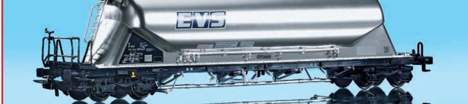
Eingestellt bei der SNCF dient der ABS-Silowagen zum Transport von Schüttgütern. Dieses Fahrzeug wird in Deutschland bei der Firma Feldbinder gebaut.
