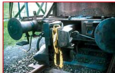
Detail-Aufnahme der AK 69 - Automatik-Kupplung für Erzwagen.
