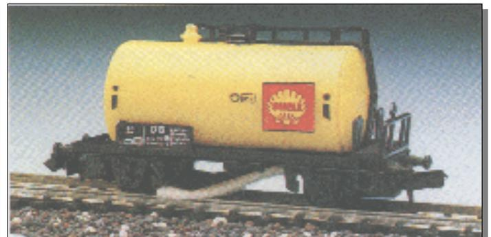
**1404 Schienenreinigungswagen**, zum Naßreinigen der Gleise, durch Füllen des Tanks mit SR 24. Mit „SHELL“ Beschriftung. Durch einfaches Abnehmen des Reinigungsschleifers auch als normaler Tankwagen zu verwenden. LÜP 55 mm
