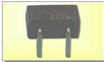
2061 Brückengleichrichter zum Gleichrichten von Wechselstrom in Gleichstrom. Z.B. zum Betrieb von Gleichstrommotoren an einem Wechselstrom Trafo. Belastbar bis 1 A. Maße 9 x 6 x 5 (10)* mm
