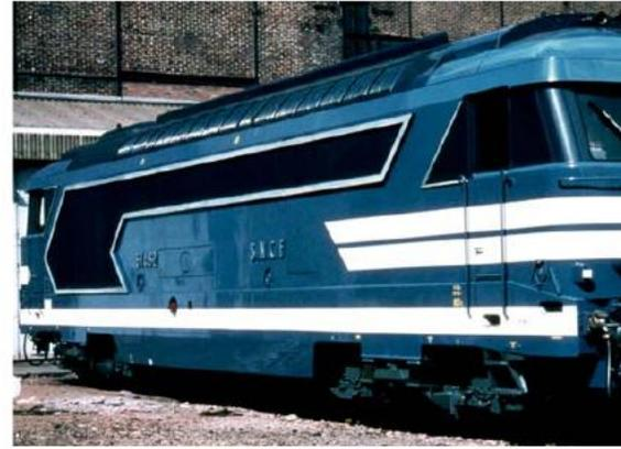
**SNCF, locomotive Diesel-électrique BB 67455, livrée bleue à plaques, avec jupes**
