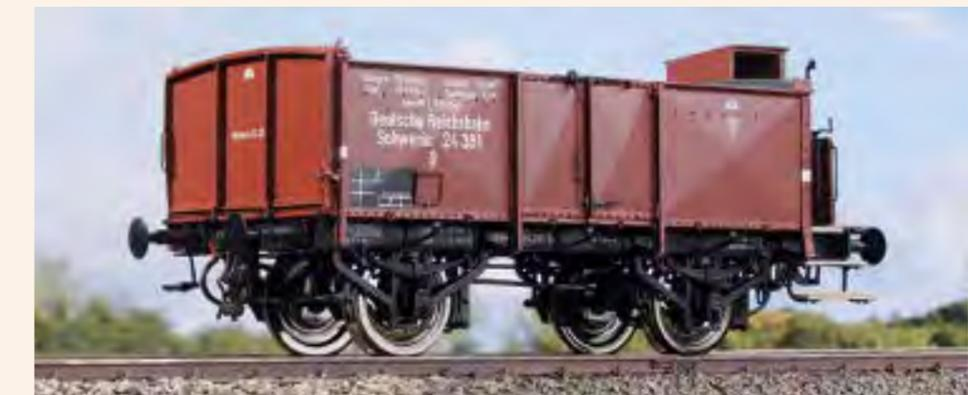
**Modell:** Das Modell besteht aus Kunststoff-Gemischtbauweise, komplettes Fahrwerk aus Metall, kugelgelagerte und gefederte Achsen, vorderechte Detaillierung und Beschriftung, Federpuffer, Schraubenkupplungen, austauschbar gegen KM1 Doppelhakenkupplung oder Klauenkupplung, beidseitig vorderechte profilierte Räder, viele angesetzte Teile, komplette Nachbildung der Bremsanlage und des Wagenkastens innen, beidseitig profilierte Buckelbleche, Mindestradius 1020 mm, LÜP 22,8 cm, Gewicht ca. 0,5 kg.
