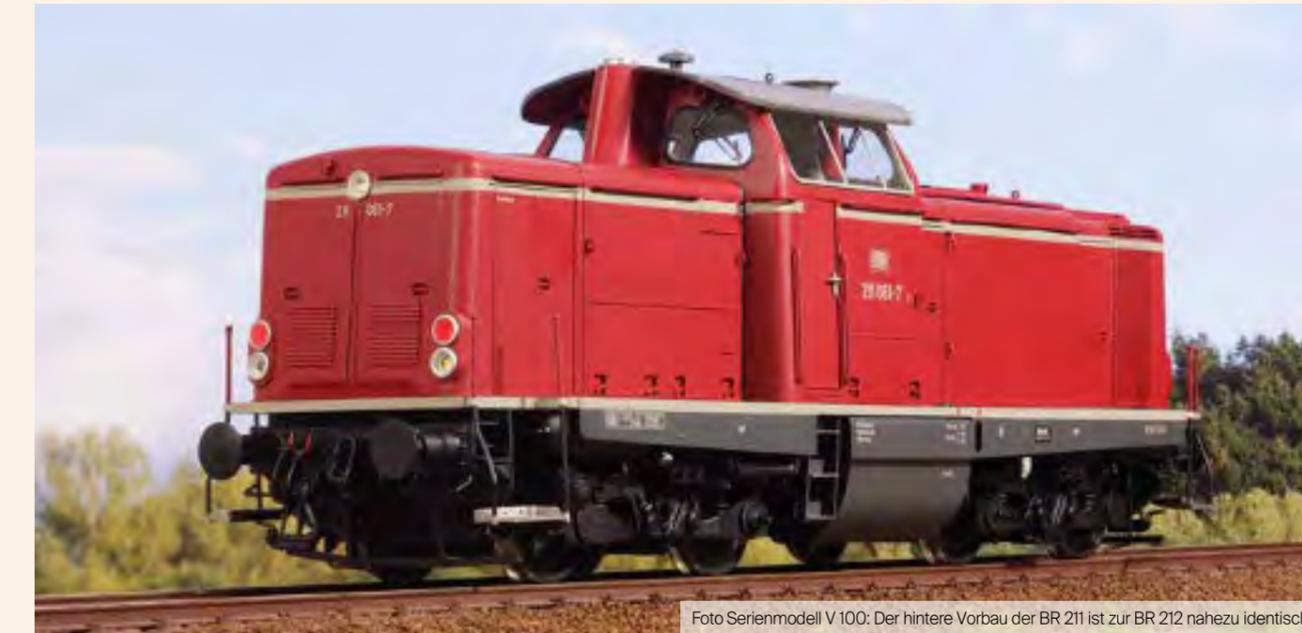
Foto Serienmodell V 100: Der hintere Vorbau der BR 211 ist zur BR 212 nahezu identisch.
