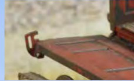
Abklappbare Stirnbordwand mit funktionsfähiger Verriegelung
