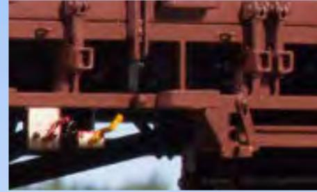
Komplett nachgebildete Bremsanlage mit Umstellhebel
