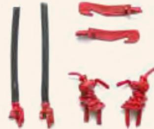
Bremserschlauch, flexibel und kuppelbar,
