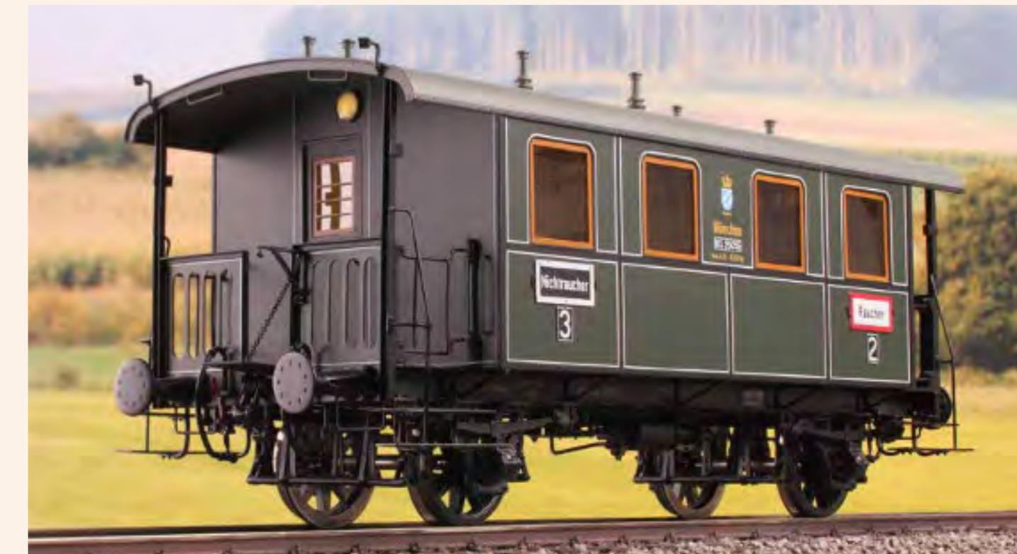
**Modell:** Handgefertigtes Präzisionsmodell aus Messing, detaillierte Inneneinrichtung, komplett detaillierte Bremsanlage und Wagenunterboden, vorbildgerechte Beschriftung, schaltbare Innenbeleuchtung inklusive Funktionsdecoder mit Strompuffer für flackerfreien Betrieb, Schraubenkupplungen gegen Klauenkupplungen tauschbar, Federpuffer, bewegliche Trittleche an Bühnen.
