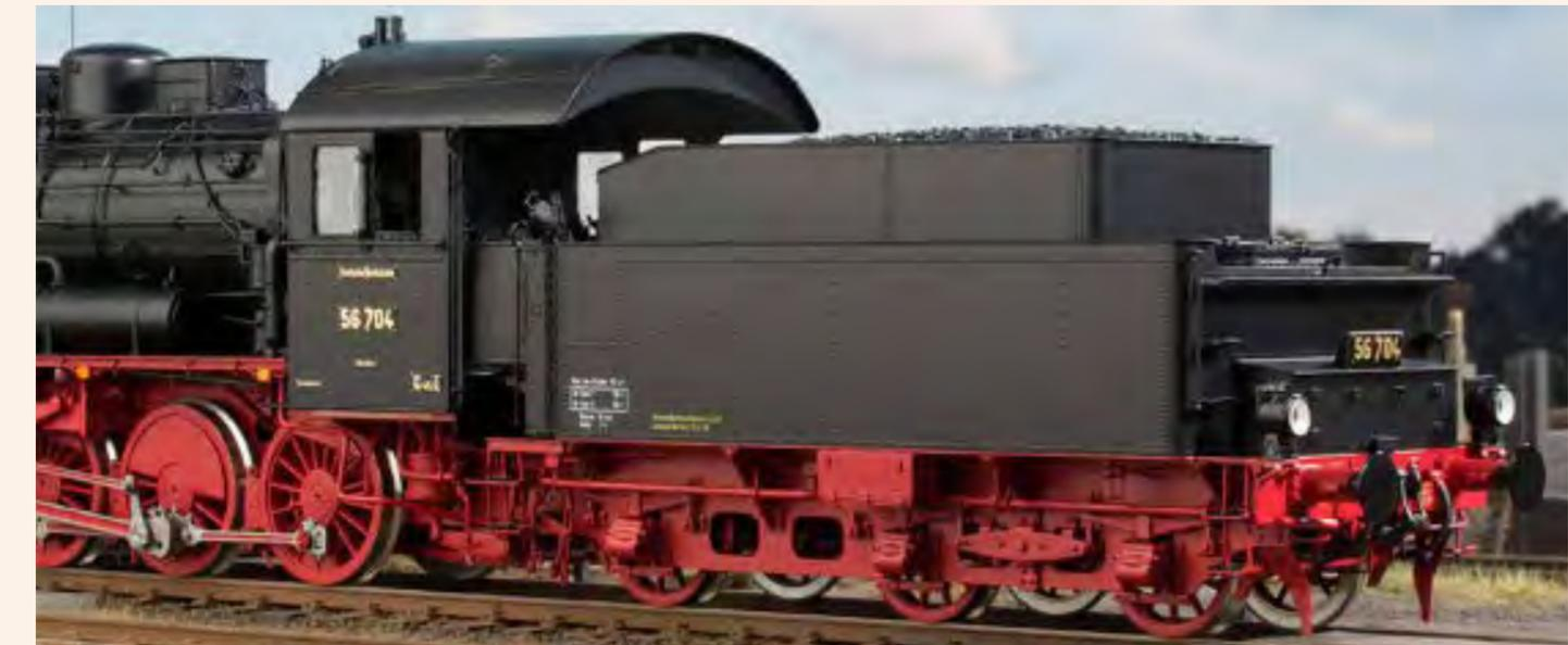
**Modell:** Präzisionsmodell aus Messing und Edelstahl, Bühler Motor, Hochleistungs-Digitaldecoder mit realistischem KM1 HQ Sound, Breitbandlautsprecher, Dynamic Smoke mit unabhängiger Zylinderdampf neuerer Generation mit dynamischer Dampfpeife, einfaches Füllen über Schornstein, servomotorische Umsteuerung von Vorwärts- auf Rückwärtsfahrt, Führerstandsbeleuchtung, Feuer-
