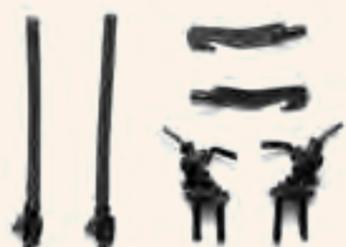
Bremserschlauch, flexibel und kuppelbar,
