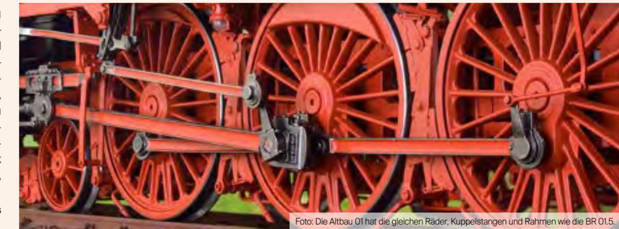
Foto: Die Altbau 01 hat die gleichen Räder, Kuppelstangen und Rahmen wie die BR 01.5.
