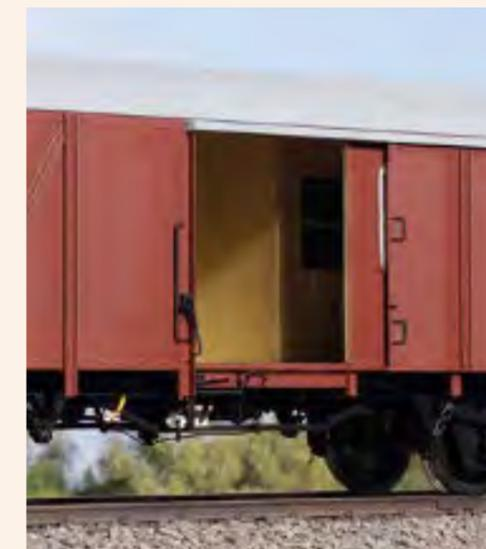
**Modell:** Handgefertigtes Präzisionsmodell aus Messing, Federpuffer, kugelgelagerte und gefederte Achsen, komplette Detaillierung des Wagenunterbodens, inklusive Bremsanlage, Schiebetüren zum Öffnen, Innenbeleuchtung mit Warmlicht LED's und Funktionsdecoder, original Schraubkuppungen, austauschbar gegen KM1 Doppelhakenkuppung oder Klauenkuppungen, vorbildgerecht beidseitig profiliert Räder, vorbildgerechte Beschriftung. LüP ca. 34,6 cm. Gewicht ca. 1,8 kg. Mindestradius 1020 mm.
