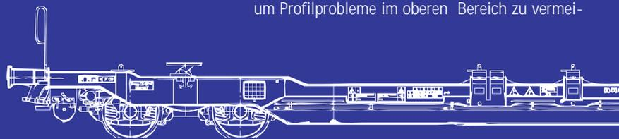
waggons für alle Ladeeinheiten – Sattelanhänger, Wechselbehälter, auch neuartige, und Container verfolgt. Obwohl mit dem MEGA II der Hupac bereits eine auch für Megatrailer geeignete Konstruktion vorlag, wurde eine Neuentwicklung innerhalb des SAIL-Projekts angestrebt. Der dabei entstandene sechsachsige Doppeltrag-
