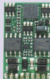
Der **N025** zählte bei Markteinführung zu den kleinsten Lokdecodern der Welt. Durch modernste Bauteil- und Leiterplattentechnologie betragen die Abmessungen des Decoders gerade einmal 11,4 x 8,8 x 3,3 mm. Der Motorausgang ist mit bis zu 700 mA belastbar, die einzelnen Funktionsausgänge können jeweils mit 150mA belastet werden. Alle Ausgänge des Decoders besitzen Schutzeinrichtungen, die im Falle eines Kurzschlusses den Decoder abschalten.
