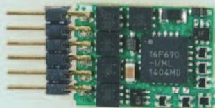
Alle Lokdecoder sind kompatibel zum DCC-Standard der NMRA. Sie können die Decoder mit allen Zentralen und Systemen verwenden, die ebenfalls kompatibel zum NMRA-Standard sind, z.B. Lenz (compact, LZV100), Uhlenbrock (Intelli-box), Arnold, Roco, Fleischmann (TwinCenter), Digitrax, Zimo (MXI) u.v.a..
