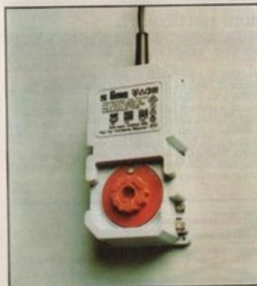
50 2054 Trasformatore. Potenza 3,6 V.A. Tensione d'alimentazione 220 Volt. Tensione disponibile per la trazione 0-12 Volt in corrente continua. Questo trasformatore è stato realizzato per il funzionamento di un treno o per accessori a corrente continua.
