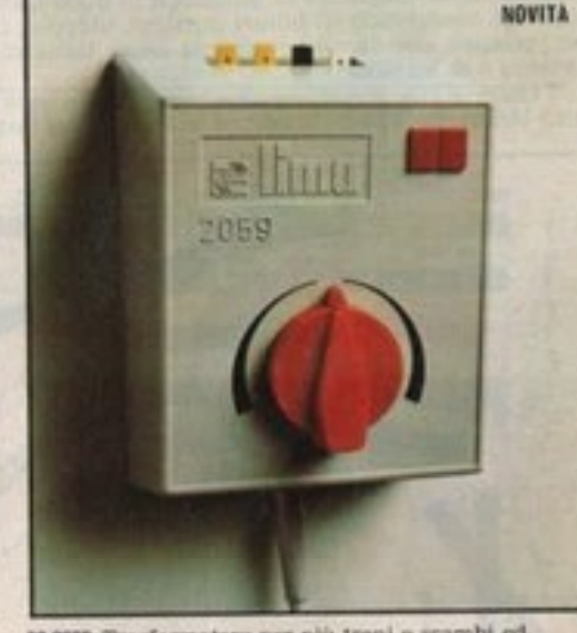
50 2059 Trasformatore per più treni e scambi ed accessori elettrici. Alimentazione a 220 V. Tensione disponibile in corrente continua 0-15 V. a 1,1 A. Tensione disponibile in corrente alternata 14 V. a 1,1 A. Protezione contro i corto circuiti a disgiuntore termico.
