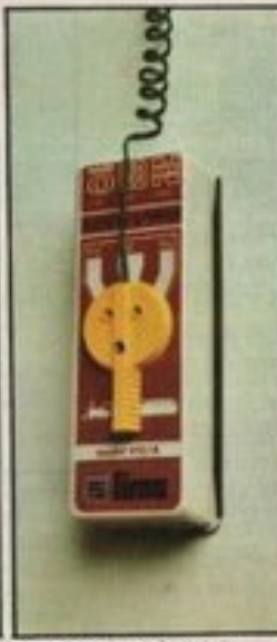
50 0012A Scatola porta pile per 6 batterie a 1,5 V., collegate «in serie». Tensione in uscita 9 V.
