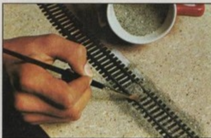
2 — spargere la sabbia lungo il binario, tra le traversine e ai lati, entro le linee di delimitazione della massiciata.
