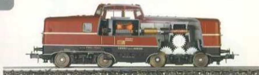
Locomotiva con motore a doppia trasmissione cardanica
