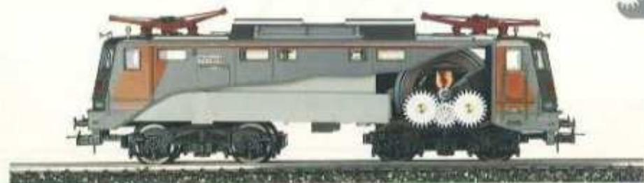
Locomotiva con motorizzazione ad alta velocità con trasmissione ad ingranaggio diretto rapporto 1:9,6
