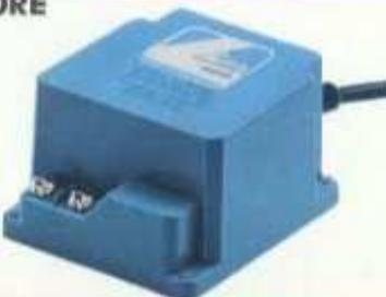
**602055** - Trasformatore per dispositivi elettromagnetici. Tensione di alimentazione in corrente alternata a 220 V. 50 Hz. Uscita 10 V. alternata. Potenza V.A. 7. Protetto contro i sovraccarichi e corto circuito.
