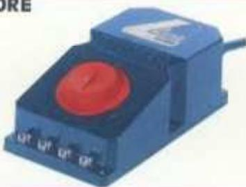
**602053** - Trasformatore per due treni e scambi ed accessori elettrici. Alimentazione a 220 V. 50 Hz. Tensione disponibile in corrente continua 0-12 V. a 0,7 A. Tensione disponibile in corrente alternata 14 V. a 0,5 A. Protetto contro i sovraccarichi e corto circuito.
