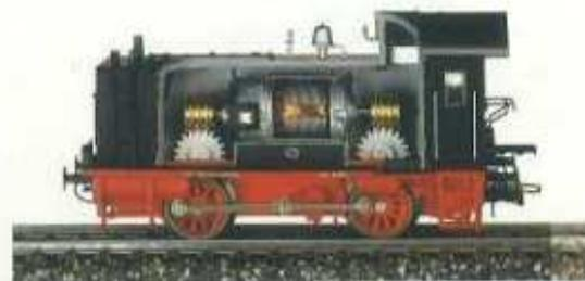
Locomotiva con motore a trasmissione singola
