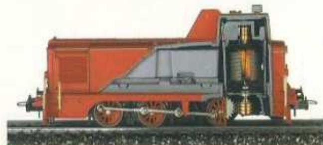
Locomotiva con motore a trasmissione cardanica singola
