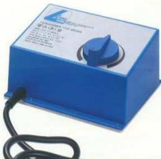
**602060** - Trasformatore per tre treni e scambi ed accessori elettrici. Alimentazione a 220 V. 50 Hz. Tensione disponibile in corrente continua 0-12 V. a 1 A. Tensione disponibile in corrente alternata 14 V. a 1 A. Protetto contro i sovraccarichi e corto circuito.
