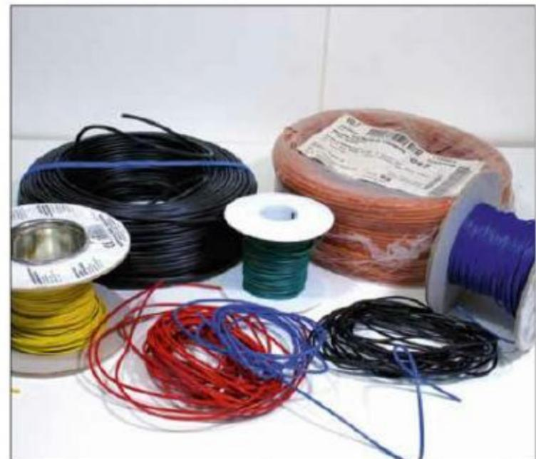
Quelques types de conducteurs :  $0,25 \text{ mm}^2$  en bobine,  $0,40 \text{ mm}^2$  en petite couronne et  $1,5 \text{ mm}^2$  souple pour les feeder, en grosses couronnes.
