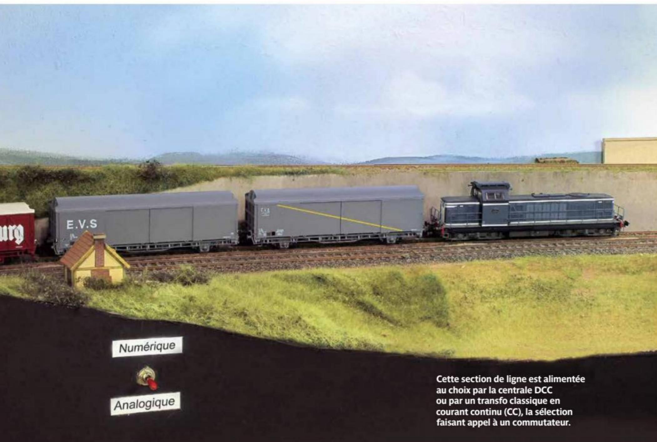
Cette section de ligne est alimentée au choix par la centrale DCC ou par un transfo classique en courant continu (CC), la sélection faisant appel à un commutateur.
