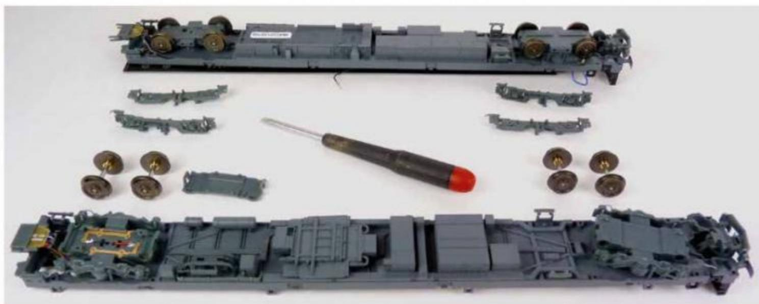
**3** Coté châssis, les flancs des bogies de la motrice se démontent sans effort, et la position des tenons évite toute erreur de remontage. Au niveau de la remorque, nous ôtons les carters des bogies en faisant levier à l'une de leur extrémité, avec un tournevis plat.
