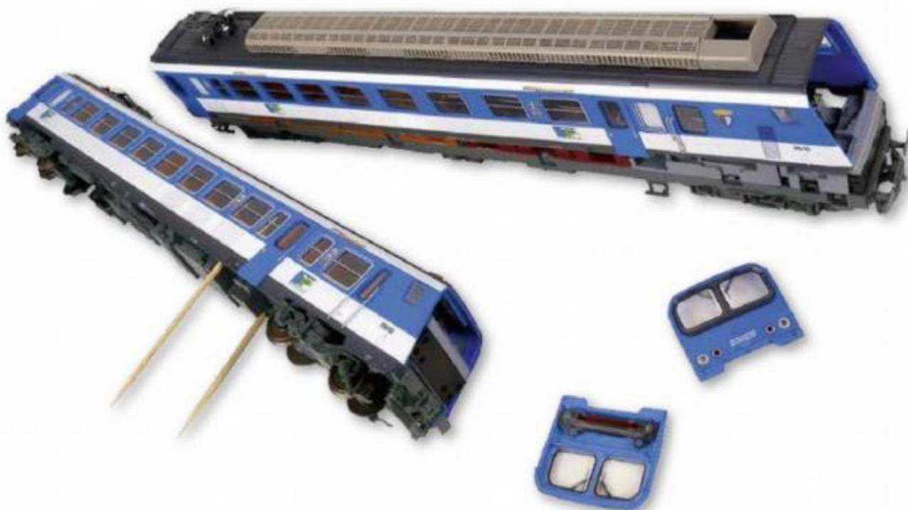
**1** La Z2 Piko se démonte aisément. Les faces avant sont juste fixées par quatre ergots. Les caisses se soulèvent en écartant les flancs. Des pics en bois facilitent l'opération.
