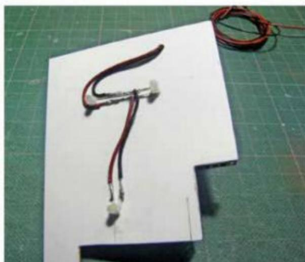
**20** Sur le dessous du plancher est collé l'éclairage du rez-de-chaussée. Il se compose de trois LED blanches pour la partie atelier et de LED jaunes pour le bureau et de la partie réservée au stockage. Le câble d'alimentation passe par le bureau de l'étage et sort à l'arrière du bâtiment.
