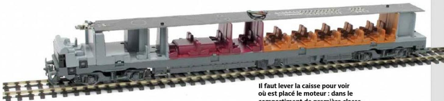
Il faut lever la caisse pour voir où est placé le moteur : dans le compartiment de première classe.
