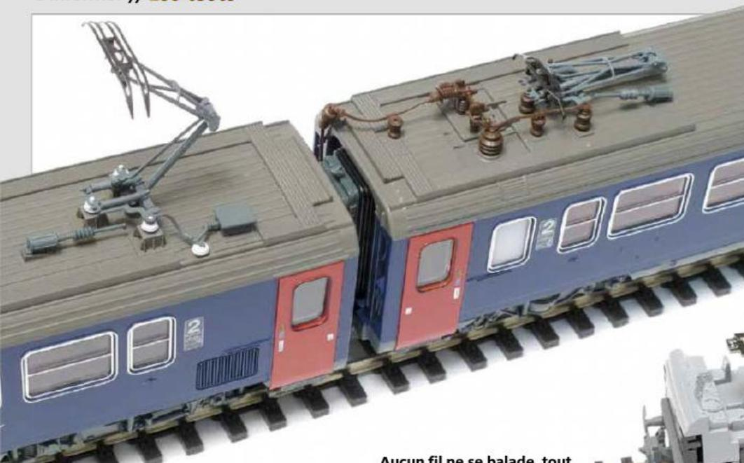
Les pantographes sont très réalistes (AM 18 B pour 1,5 V à gauche, AM 18 U pour 25 kV à droite), mais la ligne de toiture mérite une petite patine.
