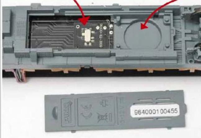
Sous une trappe, sous le châssis, un emplacement pour décodeur DCC et haut-parleur. Un petit interrupteur permet d'éteindre l'éclairage intérieur (sous alimentation analogique).
