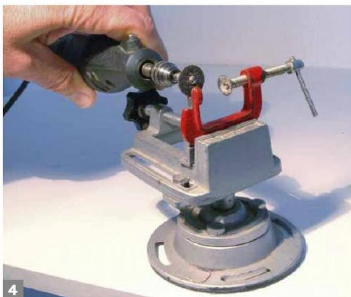
**4** Une miniperceuse avec un disque très fin est utilisée pour usiner la gorge nécessaire après perçage. Cet évidement ne doit pas excéder 2 mm de large afin que les pignons puissent se caler parfaitement pendant le montage ou le démontage des essieux.
