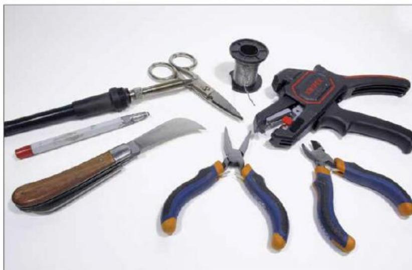
Les outils : couteau d'électricien, pince à dénuder, à couper de côté, plate, stylo fibre, ciseaux d'électricien, fer à souder et soudure
