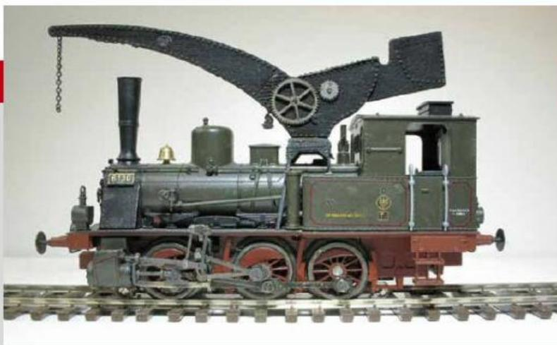
La grue peut être montée sur n'importe quelle petite locomotive tender industrielle de type 020 T ou 030 T.
