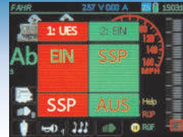
Anzeige (überlagertes Fenster) im Falle eines Kurzschlusses auf Schiene 1. Touch-Felder zum Wieder-Einschalten oder
