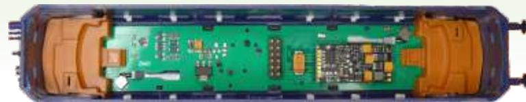
Lokplatinen der E10 in H0, eingebaut im Modell, mit Ansteuerung für die Mikro-Motoren der Panto-Antriebe und deren Endabschalter; Federkontaktleiste zur Dachplatine der Lok und 22-polige Buchsenleiste mit aufgestecktem Decoder MX645P22.
