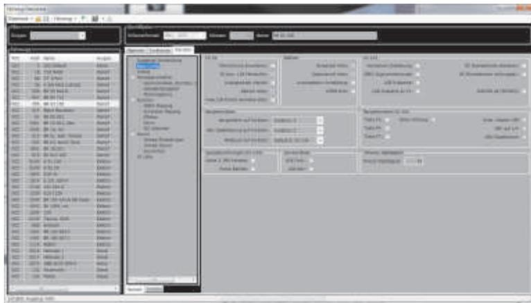
Im Computer-Tool kann auch die komplette Decoder-Konfiguration (CVs) für die in der Objekt-Datenbank enthaltenen Fahrzeuge erstellt werden.
