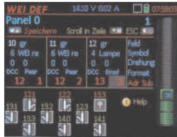
Die Bildschirmdarstellung zur Definition eines Weichen-„Panels“ (auch Vorstufe zum Stellwerk): Symbole (= Stellwerk-Tischfelder), Drehrichtung, Decoderadresse werden zugeteilt.
