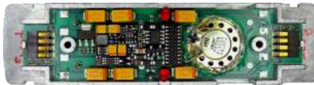
Lokplatinen einer schwedischen „Class Du“ mit aufgestecktem Sound-Decoder MX644 (MTC-Schnittstelle). Integriert auf der Platine ist ein Energiespeicher aus 6 Tantals (gesamt 1300 µF).
