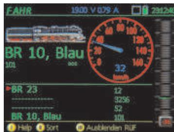
Auswahl und Aktivierung eines Fahrzeugs aus dem „RUF“ (Rückholpeicher) in der untereren Bildschirmhälfte.
