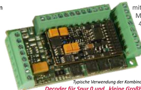
mit aufgestecktem MX634C oder MX644C
