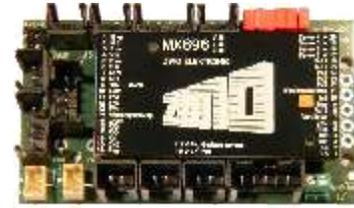
Spezial-Lokplatine für die TrainLine HSB Mallet; oben mit aufgestecktem Decoder MX696S.
