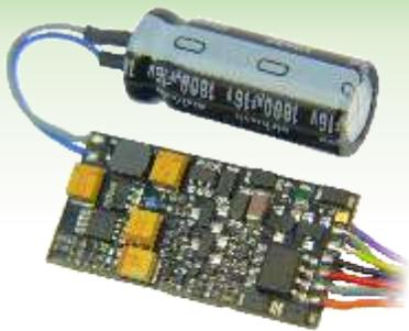
Energiespeicher werden am Decoder angeschlossen . . .
