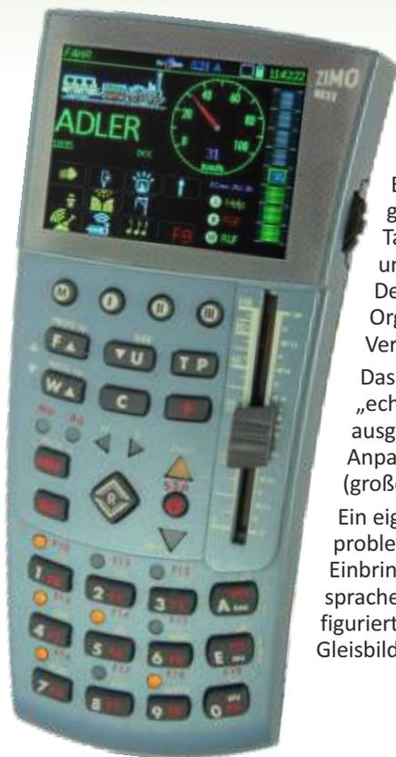
Die spezielle Gehäuseform des MX32 legt die wahlweise Verwendung als Tisch-Fahrpult oder als Walk-around Handregler nahe. Der Touch-Screen mit 2,4 " und einer Auflösung von 320 x 240 Pixel ist die Voraussetzung für die Funktionalität und Bedienerfreundlichkeit des Gerätes und damit des gesamten Systems.
