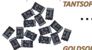
Tantal - Sortiment (30x 220  $\mu$ F, o.ä.) für 2 bis 4 ZIMO Decoder (10 bis 20 pro Decoder) mit direktem Energie-Speicher-Anschluss „16 V“
