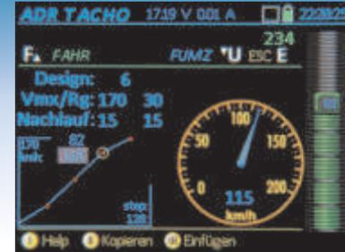
Einstellung des Zusammenhangs zwischen Fahrstufe und Geschwindigkeit (vor allem wichtig, wenn Decoder ohne RailCom-Rückmeldung im
