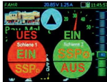
◀ Kurzschluss auf Schiene 1, der Strom wird abgeschaltet! Sofort wird in allen Fahrpulten das Stopp-Fenster mit dem aktuellen Zustand der Schienenausgänge sowie der weiteren Möglichkeiten gezeigt. Ein TOUCH auf die jeweilige Fläche am Bildschirm führt zurück zu FAHR oder zum Sammelstopp.
