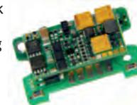
*Die spezielle Lokplatine mit aufgestecktem MX648P16 für Fleischmann „Berg“ Lok. (BR 98)*
