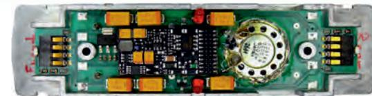
*Lokplatine in einer schwedischen „Class Du“ mit aufgestecktem MTC-Sound-Decoder MX644. Platine mit integriertem Energiespeicher (6 Tantals, gesamt 1300 µF).*
