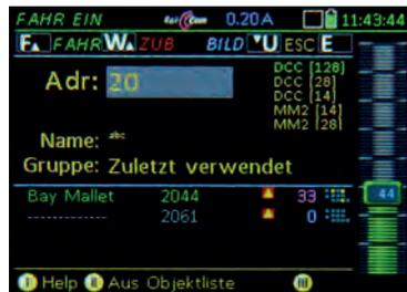
◀ Um ein neues Triebfahrzeug einzugeben, ist nur die Adresse nötig, danach kann man die Lok schon steuern. Weitere Informationen können gleich oder später eingegeben werden. Bei der Namensangabe werden Fahrzeuge mit ähnlichem Namen aus dem Speicher angezeigt.
