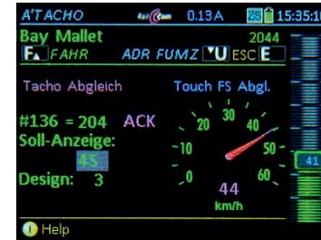
◀ Mit ZIMO Decodern (oder Decodern anderer Fabrikate mit RailCom) wird die echte Geschwindigkeit mittels RailCom Rückmeldung angezeigt. Der Bildschirm links dient dem automatischen Abgleich des Tachos durch direkte Programmierung der CV # 136.
