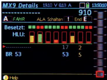
◀ Einstellungen für HLU Fahrstufen (eine ZIMO Spezialität): dieses Bild zeigt den Zustand von Gleisabschnitten eines MX9 Moduls. Besetzmelder, HLU Fahrstufen (max. 7 Fahrstufen) und die erkannte Triebfahrzeugadresse.
