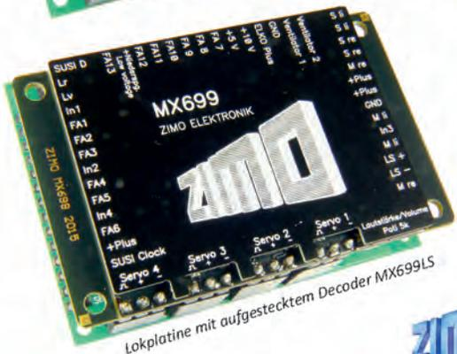
Lokplatinen mit aufgestecktem Decoder MX699LS
