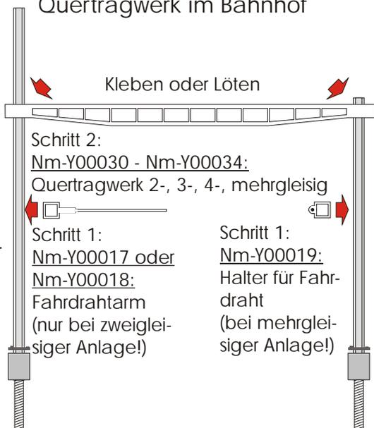
Schritt 2: Nm-Y00030 - Nm-Y00034: Quertragwerk 2-, 3-, 4-, mehrgleisig
