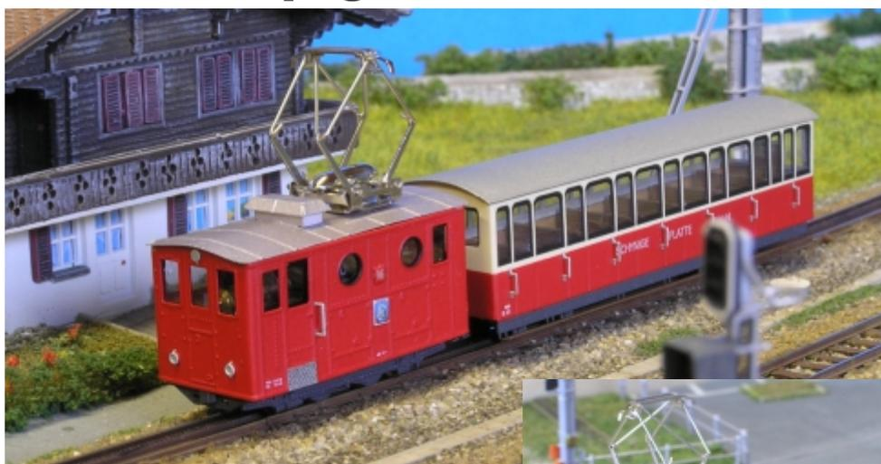
Die Motorisierung der Schynige Platte-Bahn-Modelle war eine besondere Herausforderung. Das komplette Gleis und der Fahrwerksbereich der Kastenlok mussten neu konstruiert werden. Eine passende Kupplung ist derzeit in der Testphase. Den Antrieb für den gerade mal 20mm messenden Winzling hat sb-modellbau in Olching für uns übernommen. Herausgekommen ist eine phantastische Modellbahn, die auch vor steilen Streckenabschnitten nicht kapituliert. So entsteht der perfekte Eindruck einer Zahnradbahn.
