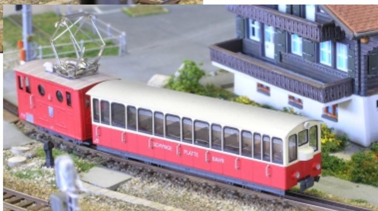
Die Schynige Platte-Bahn ist ein echtes Kleinod im Herzen des Berner Oberlandes. Mit der Motorisierung der winzigen Kastenlok kommt nun endlich Bewegung auf die 4,5mm Gleise. Der Antrieb von sb-modellbau aus Olching ist aus Messing gefräst, läuft mit gut aufeinander abgestimmten Modul02-Zahnradern und einem kraftvollen 12 Volt Maxon-Motor. Problemlos lässt sich so das Vorbild nachahmen!
