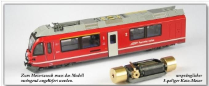
**KT-109.1:** Motortausch bei RhB ABe8/12 3501, von Original-Kato- auf sb-modellbau Maxon 0816-Motor
