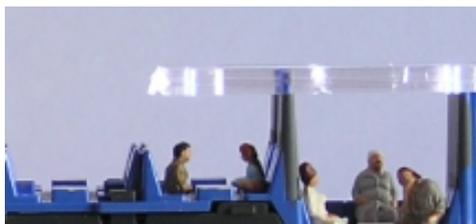
Die Kato-Lichteinheit ist eine einzelne LED, die über ein Kunststoff-Klarteil das Licht im Wagen verteilt. Dabei bricht sich das Licht an den im Kunststoff eingegossenen Aussparungen und Vertiefungen relativ ungleichmäßig.
