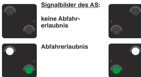
In der linken Spalte haben wir das Abfahrbefehl-Signal erläutert, folglich sind dort auch die beiden möglichen Signalbilder des AS dargestellt: das unbeleuchtete Signal erteilt verständlicherweise keine Abfahrerlaubnis, das grün-weiße Signal hingegen erlaubt die Abfahrt.
