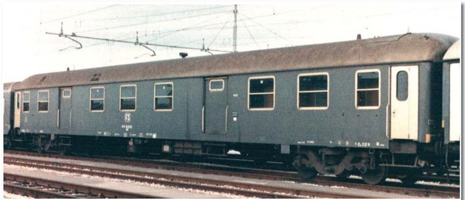
Carrozza postale Tipo UIC X 1976 destinata al trasporto di valori. Spie luminose laterali e lampeggianti sul tetto funzionanti.
