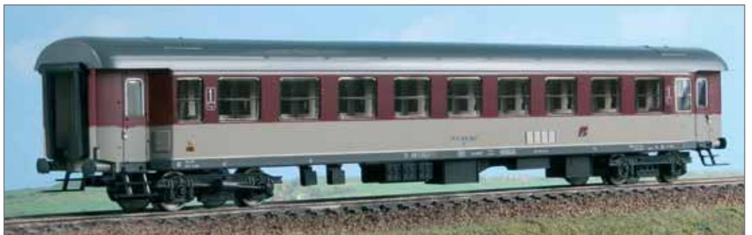
Carrozza FS di 1° classe Tipo 1946T (serie Az 23000) in livrea beige e rosso fegato appartenente alla sottoserie dotata di intercomunicanti di tipo moderno. Finestrini Tipo Klein, carrelli FS 24. Epoca IV/V - 1<sup>st</sup> class Type 1946T (Az 23000) car of the FS with new transition doors. Type FS 24 bogies and Type Klein windows, beige and deep red livery. Epoche IV/V
