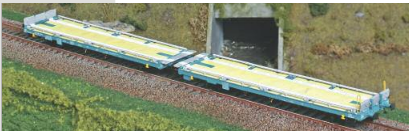
Carro pianale tipo Laadgrs per trasporto veicoli di grandi dimensioni, utilizzati in treni blocco su relazioni nazionali ed internazionali Type wagon for trucks transport, used in national and international trains. Flachwagen Typ Laadgrs für Lieferwagen und größere Fahrzeuge, in Ganzzügen national wie international eingesetzt.
