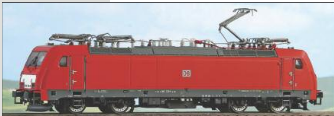
Locomotiva politensione E 186 340 di DB Schenker per i treni internazionali tra Belgio, Germania, Francia. Multi System E 186 340 DB Schenker used for goods trains between Belgium, Germany and France. E-lok E 186 340 der DB Schenker für internationale Güterzüge zwischen Belgien, Deutschland und Frankreich.
