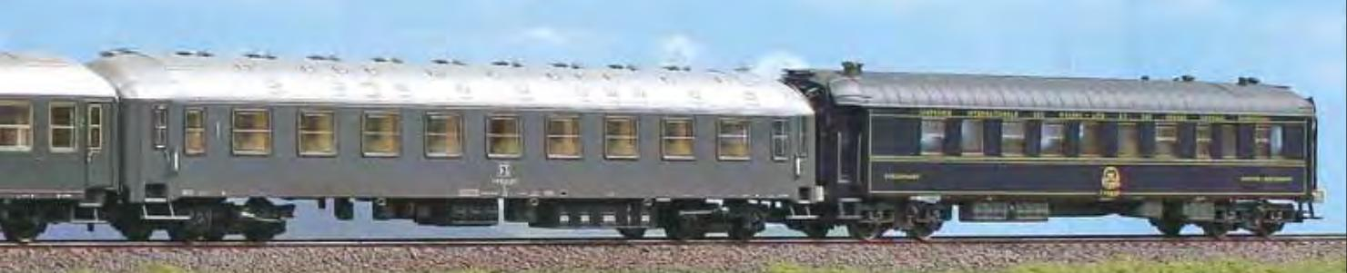
Set di tre carrozze con filetto rosso per treni Rapidi, composto da una carrozza ristorante Tipo 1925R Pistoiesi, una carrozza UIC-Y di prima classe con impianto di condizionamento Galileo e una UIC-X 1968 di seconda classe.
