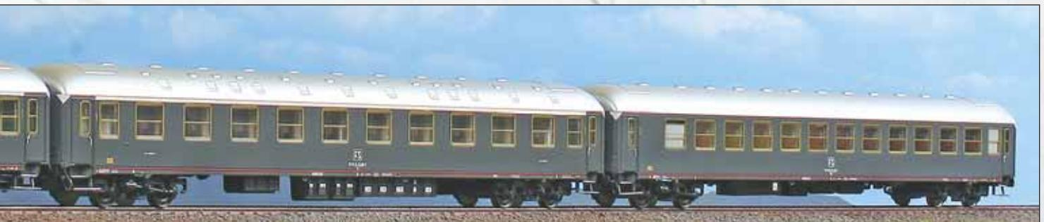
Set di tre carrozze tipo UIC-X 1968 con filetto rosso, idonee a viaggiare a 180 km/h, per treni Rapidi sulle direttive Torino-Napoli e Milano-Roma, di cui due di prima classe (una con impianto di climatizzazione Galileo) e una seconda classe con comparto ristoro.
