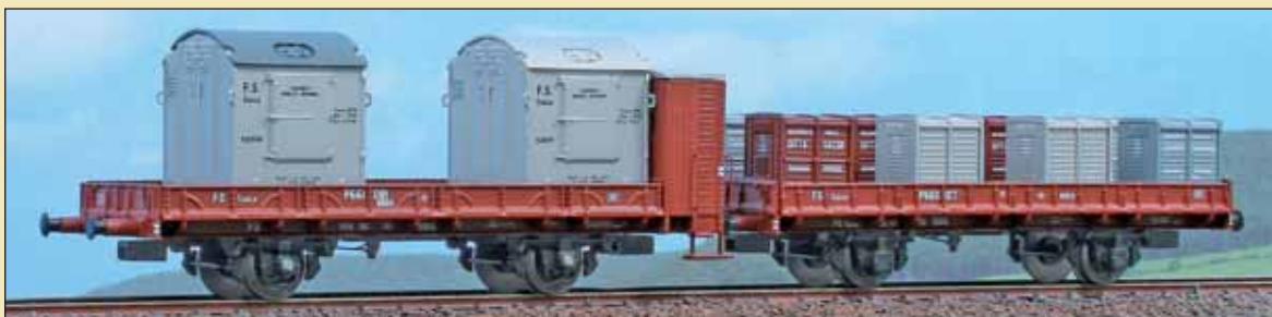
Set di due carri FS Tipo P di cui uno con garitta entrambi con carico di casse mobili FS di varie dimensioni. Set of two FS wagons "P Type", one with brakehouse, both loaded with different types of swap bodies. Set aus zwei FS-Wagen Typ P, einer mit Bremserhausschen, beide beladen mit FS-Wechselpritschen in verschiedenen Größen.
