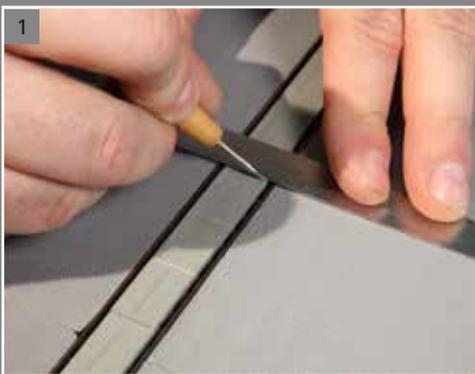
Die Gleisbohlen des Art. 41 617 sind ohne Fugen. Mehr Vorbildnähe wird erreicht, wenn Sie alle 2 cm mit einer Reißnadel Querlinien einritzen.
