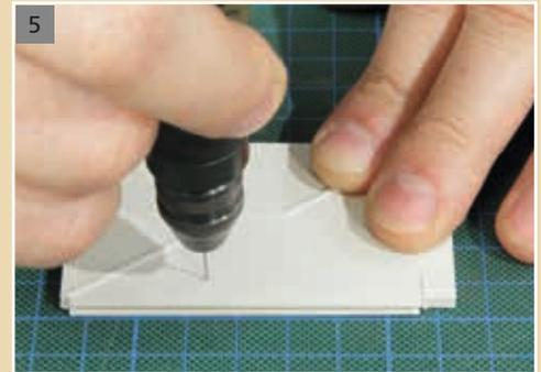
Nachdem die beiden Wandteile mit einem Seitenschneider abgetrennt wurden, legen Sie sie absolut deckungsgleich übereinander und bohren mit einem 0,5 mm Bohrer an den markierten Stellen. Somit wird gewährleistet, dass die Handläufe an beiden Wänden in gleicher Höhe angebracht werden.
