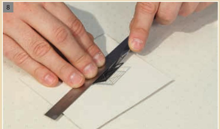
Das Lineal mit der einen Hand fest andrücken und mit der anderen die Messerklinge mit dem Torflügel direkt am Lineal langsam und vorsichtig nach oben drücken. Niemals frei Hand biegen!
