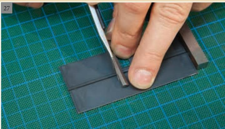
Mit Hilfe eines Winkels ist es möglich, gleich beide Dachflächen zu kürzen. Die Gauben werden nach Bauanleitung eingesetzt.
