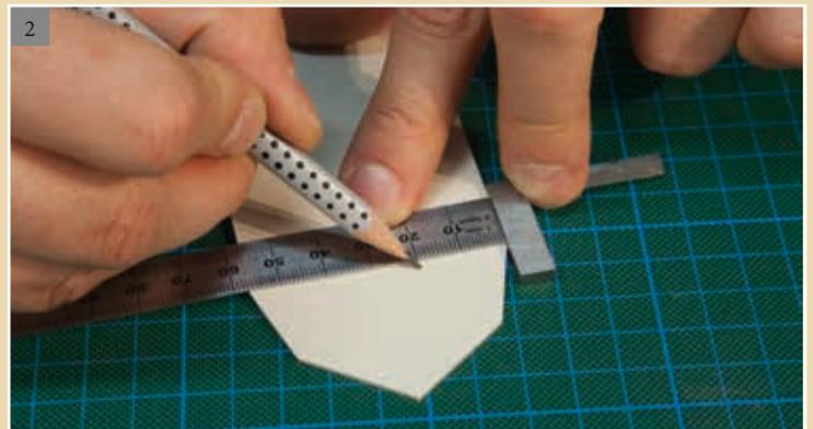
Von den Giebelwänden müssen 20 mm entfernt werden. Sie messen mit einem Stahllineal und kleinem Winkel. Die markierten Punkte verbinden Sie zu einer Linie. Das ist die Schnittkante.
