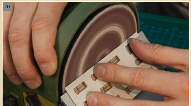
An der Schnittkante muss nun eine Fase von 45° analog der Originalhauswand angeschliffen werden.
