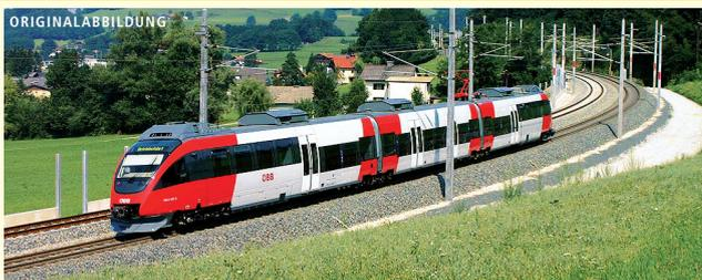
Die dreiteiligen Triebzüge Reihe 4023 werden im Nahverkehr um Salzburg eingesetzt. Der erste der Triebzüge wurde bereits im Juni 2003 geliefert, durch administrative Probleme verzögerte sich die Zulassung bis April 2004. Das dreiteilige Fahrzeug hat eine Länge von 51,12 m und eine installierte Leistung von 1.440 kW. LIEFERTERMIN: ENDE 2007
