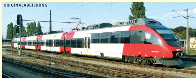
Die vierteiligen Talente der Reihe 4024 werden im S-Bahn-Verkehr der österreichischen Hauptstadt Wien eingesetzt. Die Züge sind insgesamt 66,87 m lang, die Motoren haben zusammen eine Leistung von 1.520 kW. LIEFERTERMIN: ENDE 2007
