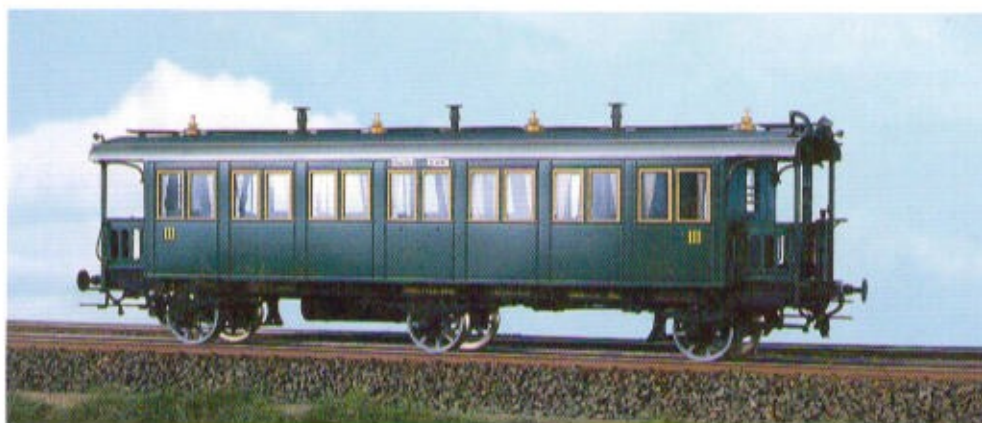
2.58.1 K.Bay.Sts.B. Personenwagen Ci für den Nahverkehr, dreiachsig mit kompletter Inneneinrichtung Ausführung mit 14 Fenstern
