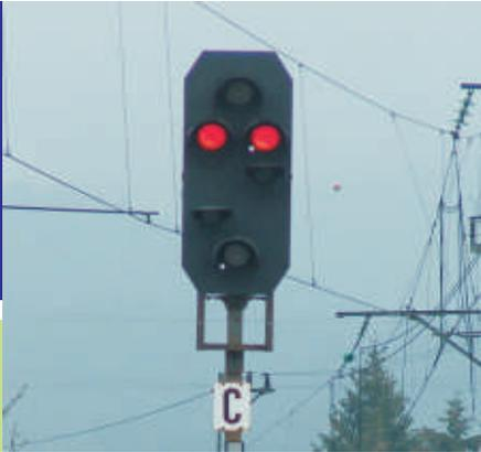
Die wohl bekanntesten und an deutschen Bahnstrecken am weitesten verbreiteten Signale gehören zur Baureihe 1959. Sie sind seit ihrer Konstruktion und Einführung in den 50er Jahren in Technik und Funktion ständig erweitert worden, bis sie schließlich nach der Zusammenlegung von DB und DR durch die Baureihe KS abgelöst worden sind.
