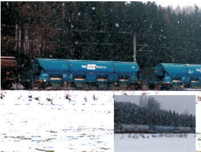
Neuester Waggon der Rail cargo Austria in funktionsfähiger Ausführung, wie er von den Salinien Austria zum Transport von Steinsalz und Salzprodukten verwendet wird.
