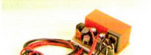
Das EFS 2c kann durch Auseinanderbrechen an der vorgesehenen Stelle (Sollbruchstelle) geteilt werden. Die drei dadurch unterbrochenen Leiterbahnen müssen mit dem beiliegenden Bandkabel wieder verbunden werden.
