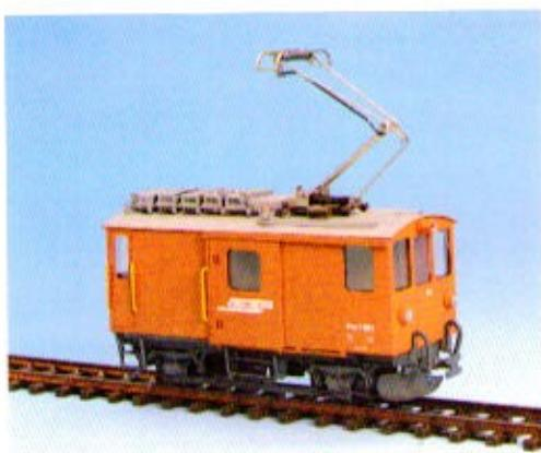
Gepäcktriebwagen für universellen Einsatz, Indienststellung 1908, max. Geschwindigkeit 45 km/h, Gewicht 13 t, Leistung 210 PS, aktuelle Ausführung.
