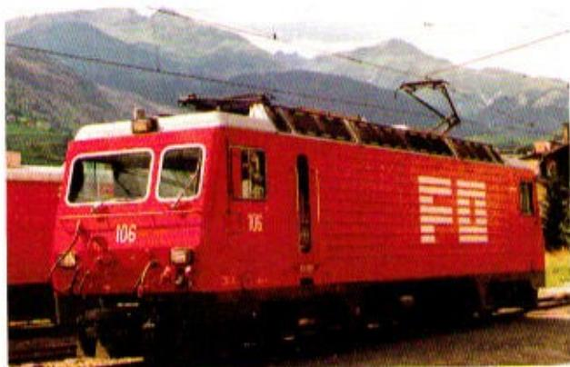
Mehrzwecklokomotive für Adhäsions- und Zahnradstrecken, Indienststellung ab 1985/86, max. Geschwindigkeit 90 km/h, Gewicht 64,0 t, Leistung 1750 kw.
