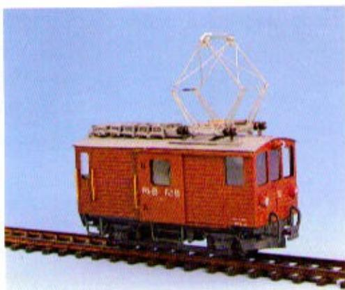
Gepäcktriebwagen für universellen Einsatz, Indienststellung 1908, max. Geschwindigkeit 45 km/h, Gewicht 13 t, Leistung 210 PS, Ausführung nach Umbau 1962.
