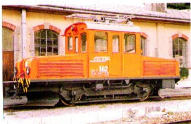
Kleine Elektrolokomotive für leichte Personen- und Güterzüge, auch als Rangier- und Vorspannlok verwendet, Indienststellung 1911, vielfach umgebaut und erneuert, in dieser Ausführung ab 1972, max. Geschwindigkeit 45 km/h, Gewicht 18 t, Leistung 330 PS.
