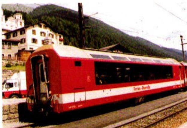
Moderner Großraum-Panoramawagen für den Einsatz im 'Glacier Express', Baujahr 1987-88, Gewicht 18,7 t, 48 Sitzplätze, Solarzellen auf dem Dach für Bordstromversorgung während der Stillstandszeiten (für Klimaanlage, Kühlschrank).
