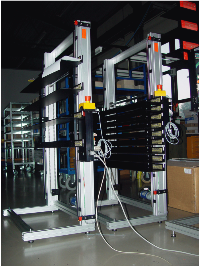
Auf diesem Bild sind bezogen auf die verschiedenen Spurgößen zwei Extreme zu sehen: Der linke LokLift ist eine Ausführung für vier Ebenen für Spur 1, der dahinter stehende ist einer mit neun Ebenen für Spur Z.
