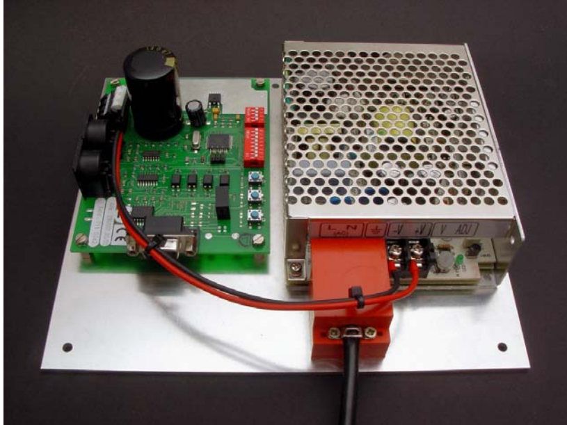
Die SX.Control 02 (hier mit RS232 ) mit Schaltnetzteil auf Aluplatte montiert.
