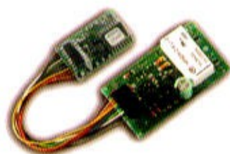
51604: LokPilot mit Schleiferumschaltungsplatine. Zum Einbau in Triebfahrzeuge für das Dreileitersystem geeignet. Lieferung mit ausführlicher Einbauanleitung.
