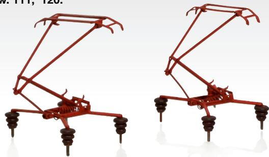
Alle Pantographen bestehen aus Neusilber. Mit Spiralfederzügen und Steckstiften zum Einstecken in 4 feine Bohrungen im Fahrzeugdach, zum Ankleben mit einem Tröpfchen Kleber. Bohrschablone wird mitgeliefert. Diese Pantographen sind nicht für "echten" Fahrdraht-berührenden Oberleitungsbetrieb geeignet (könnten evtl. an Lücken im Fahrdraht hängenbleiben). Sind jedoch in fixer Höhe arretierbar, indem man die Scharniergelenkdrähtchen sehr vorsichtig mit einer Zange zusammendrückt.
