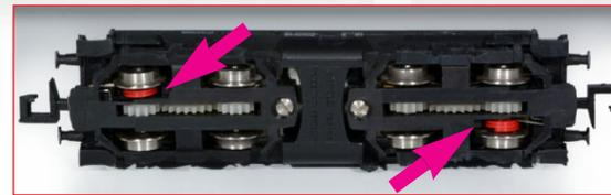
**"SIMPLEX"-Rangierkupplung** Geniale ARNOLD-Erfindung: Die Kupplung klappt nach raschem Aufdrehen des Trafo-Reglers nach oben und entkuppelt dann. Die Kupplung wird nur mechanisch mittels eines (roten) Schneckenrads, das ein Stell-Drähtchen bewegt, nach oben gedrückt. Loks mit SIMPLEX-Kupplung können problemlos verwendet werden, auch wenn KEINE Entkuppelungsfunktion gewünscht ist.
