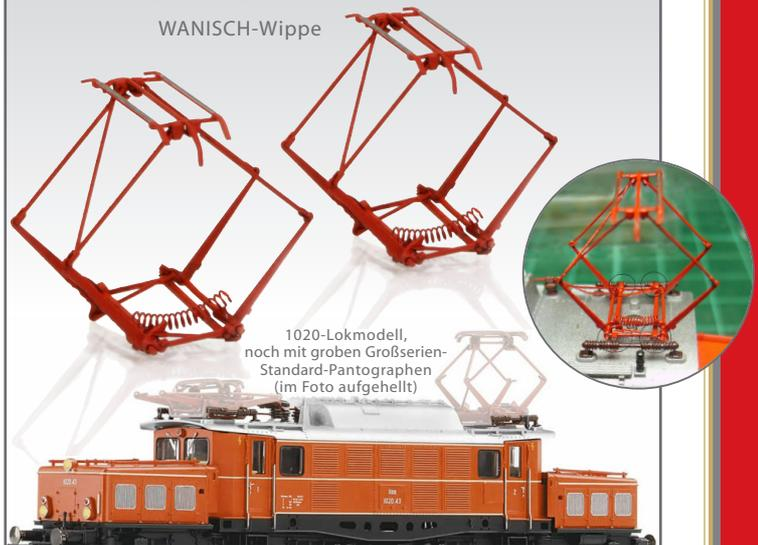
Alle Pantographen bestehen aus Neusilber. Mit Spiralfederzügen und Steckstiften zum Einstecken in 3 bzw. 4 feine Bohrungen im Fahrzeugdach, zum Ankleben mit einem Tröpfchen Kleber. Bohrschablone wird mitgeliefert. Diese Pantographen sind nicht für "echten" Fahrdrabt-berührenden Oberleitungsbetrieb geeignet (könnten evtl. an Lücken im Fahrdrabt hängenbleiben). Sind jedoch in fixer Höhe arretierbar, indem man die Scharniergelenkdrähtchen sehr vorsichtig mit einer Zange zusammendrückt.
