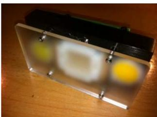
**Mit dem DMXRGB-Modul lassen sich fünf 10W-High-Power LED Module ansteuern.**
