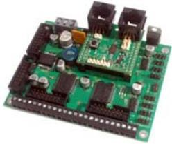
Die OneControl aus der OneSerie wird ein BiDiB-Decoder der Extraklasse. Dieser neuer Baustein ist in der Verwendung und der Konfiguration vergleichbar mit der LightControl Baugruppe, deshalb wird dieser auch einen Platz neben der LightControl einnehmen.
