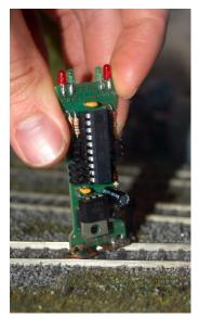
Eine Abhilfe schafft diese kleine Baugruppe, welche einfach direkt auf das Gleis gestellt wird und die richtige DCC-Polarität anzeigt.
