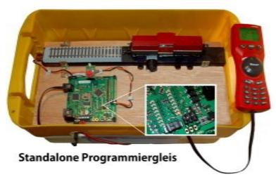
**GBMboost** - Ein Baustein der zugleich Zentrale, Booster und mit dem GBM16T zusammen, ein 16facher Belegtmelder ist, wurde noch um eine weitere Funktion erweitert – das Programmiergleis!
