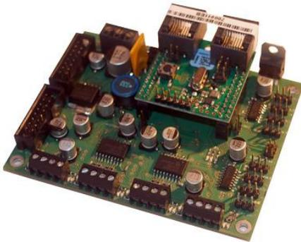
Diese neue Hardware ist eine Abwandlung der bekannten **OneControl Baugruppe** aus der OneSerie. Die Erneuerung ist, dass diese Baugruppe mit Hilfe eines Motortreibers in der Lage ist, acht Motorantriebe zubewegen. Mit dieser Baugruppe könnte man motorische Weichen, Hoffmann-Antriebe oder die bekannten Conrad-Antriebe ansteuern.
