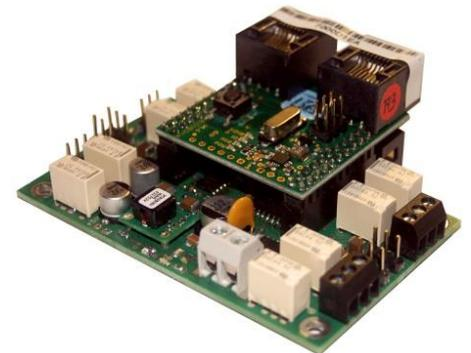
Das OneST Grundboard hat eine GBM16T Schnittstelle, dass weitere GBM16T Rückmelder von einem externen GBMboost versorgt werden können. Diese Modifizierung ist für Kleinspurbetreiber und Modulbauer eine weitere hilfreiche Erweiterung.
