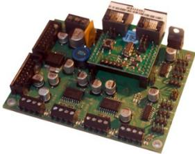
Die OneControl ist eine Baugruppe aus der OneSerie, die durch ein Hardware-Update und einem Firmware-Update, eine GBM16T-Schnittstelle bekommt. Nach dem Update kann an der OneControl ein GBM16T (16-fach Belegtmelder) angeschlossen werden. Es reduziert sich bei Verwendung der Schnittstelle die Servoanzahl von 8 Ausgängen auf 4 Ausgänge.
